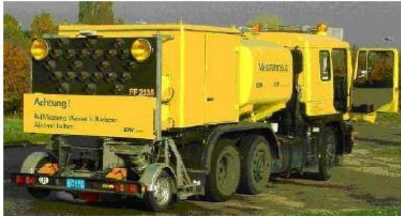
Figura 25 – Equipamento Stuttgarter Reibungsmesser (TYROSAFE, 2008).
