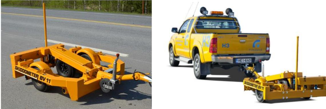
Figura 19 – Equipamento BV11 – Skiddometer (GDDKiA, 2009).
