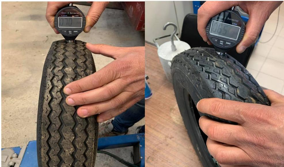
Figura 62 – Leitura dos valores da dureza.
