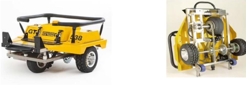
Figura 20 – Equipamento GripTester (Harverson, 2003).
