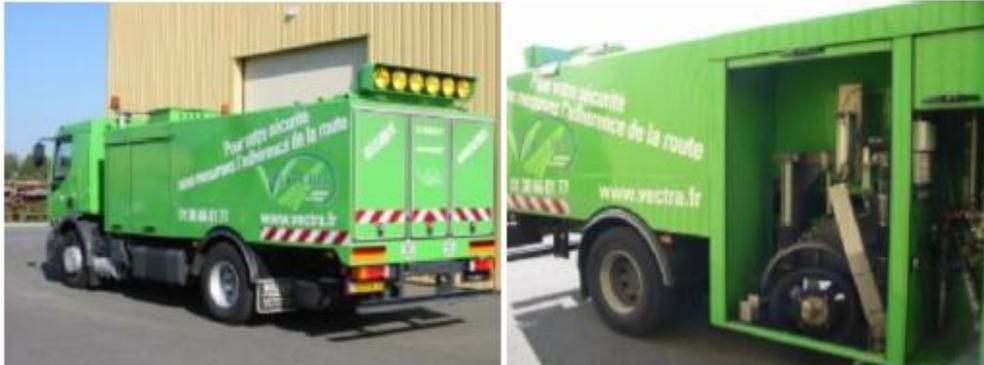
Figura 18 – Equipamento SCRIM (Descornet et al., 2006)
