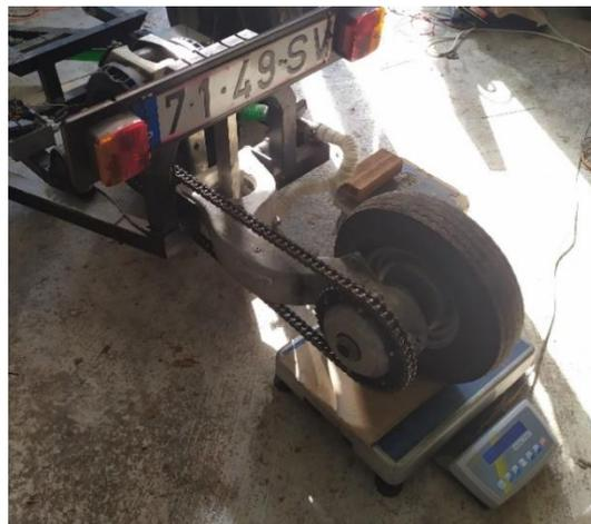
Figura 33 – Medição do peso sobre a roda
