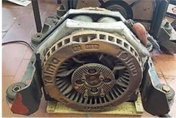
Figura 30 – Travão eletromagnético Telma AD50-55 (Machado, 2017).
