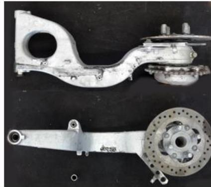
Figura 31 – Monobraço traseiro de uma Honda VRF (Machado, 2017).
