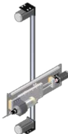
Figura 3.10 - Modelação 3D do sistema de movimento do eixo de translação X (vertical) (Silva, 2021).
