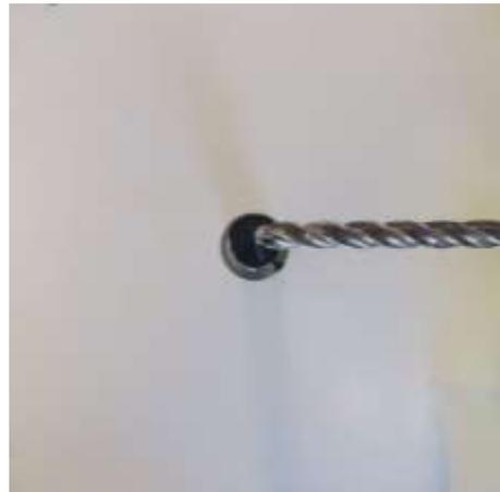
Figura 4.71 - Alinhamento do eixo do Z (vista de cima) para marcar o zero peça.
