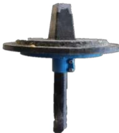
Figura 3.32 - Prato de maquinagem (base do molde).
