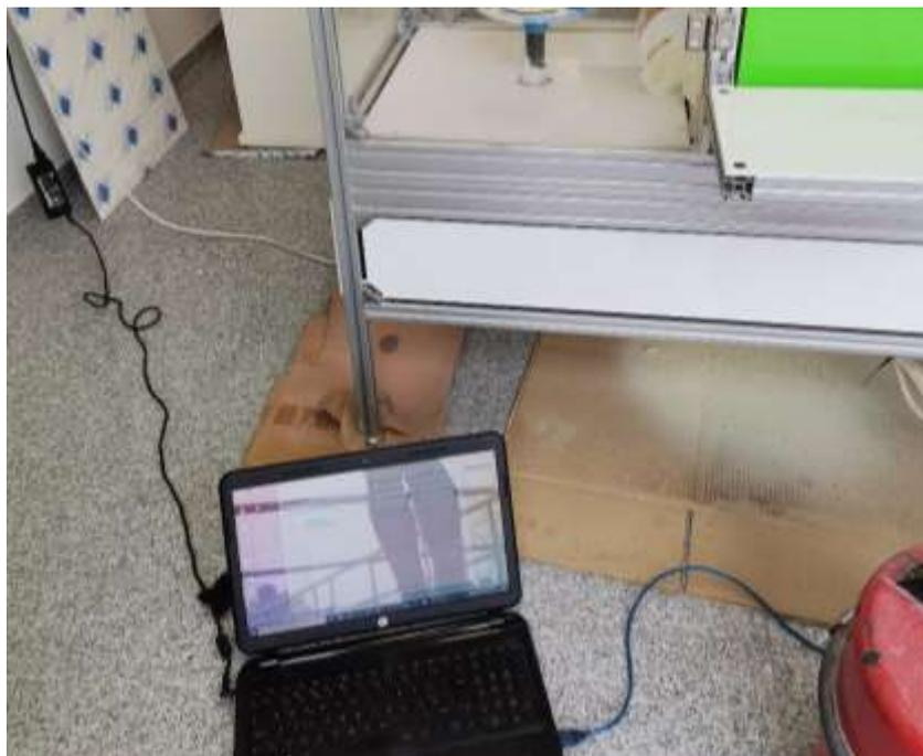
Figura 3.37- Ligação do controlador (Grbl Controller) à máquina para ativação do canal de comunicação.
