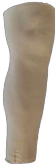
Figura 3.40 - Molde positivo da perna do utente maquinação na CNC da Padrão Ortopédico.
