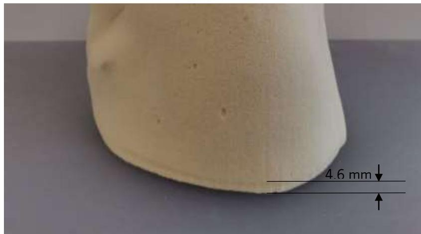
Figura 4.67 - Excesso de material na peça final cortada.
