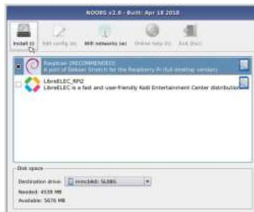
Figura 4.8 - Instalação do Sistema operativo presente no cartão SD no Pi4B (Raspberry Pi (Trading) Ltd., 2020).
