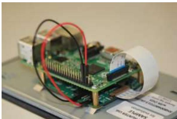
Figura 4.6 - ligação do Raspberry Pi4B ao ecrã tátil (Raspberry Pi (Trading) Ltd., 2019c).
