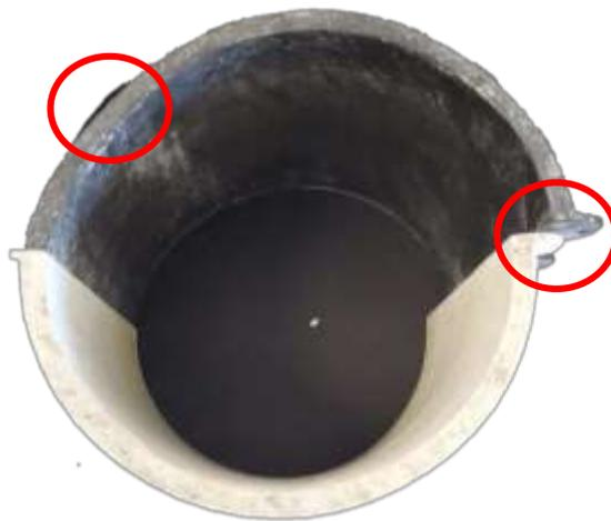
Figura 3.46 - Deformações causadas nos moldes de PLA pela pressão do poliuretano de baixa densidade em reação.
