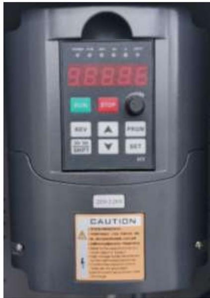
Figura 3.39 - Controlador da Spindle.
