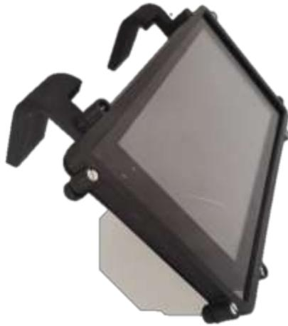
Figura 4.79 - Raspberry Pi4 modelo b e ecrã de 7" com suporte.
