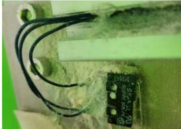
Figura 4.68 - Limit Switch SS implementado na CNC.
