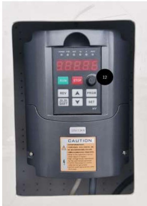
Figura 15 - Ativar a spindle.
