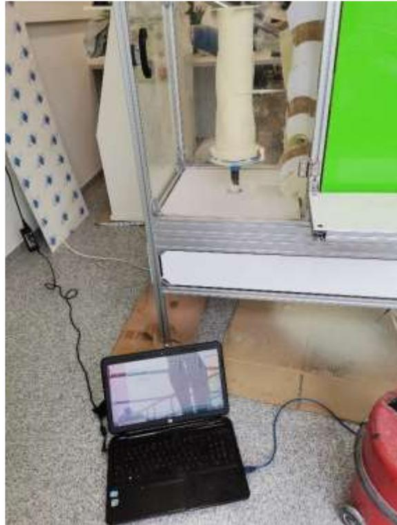
Figura 3.42 - Ligação do computador à Máquina CNC.
