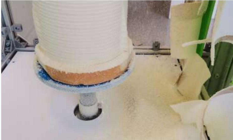
Figura 3.43 - Deposição do pó do desbaste na CNC e nos seus componentes.
