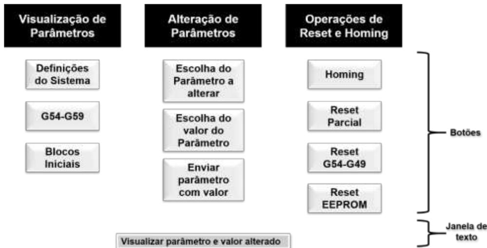
Figura 4.17 - Objetos necessários na parte remetente para as definições e parâmetros do Grbl.
