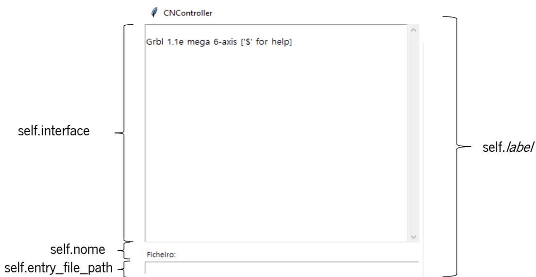
Figura 4.40 - Identificação dos objetos da janela de comunicação correspondentes às variáveis programadas.
