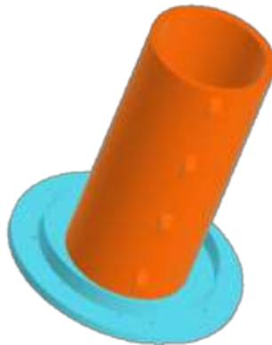
Figura 4.75 - Modelação CAD dos moldes cilíndricos com dimensões 120 x 300 mm.
