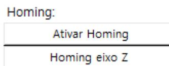
Figura 4.72 - Botões para ativar o homing (\$22=1) e para fazer homing ao eixo do Z (\$Hz), respetivamente.
