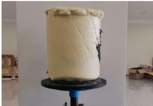
Figura 4.73 - Bloco de Poliuretano de baixa densidade no prato da CNC.
