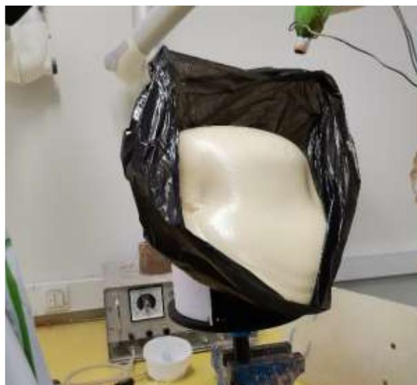
Figura 3.34 - Formação do bloco de poliuretano de baixa densidade.
