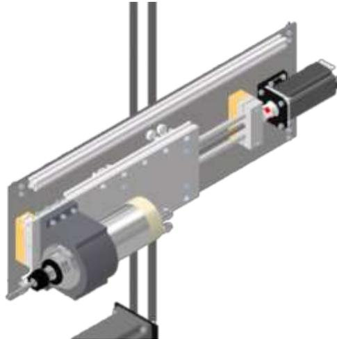
Figura 3.11 - Eixo de movimento Z (Modelação 3D) (Silva, 2021).
