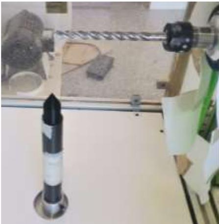
Figura 4.70 - Alinhamento do eixo do Z para marcar o zero peça.
