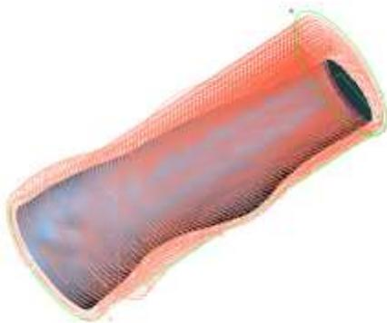
Figura 3.26 - Caminhos percorridos pela ferramenta na operação de desbaste.
