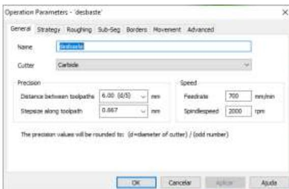
Figura 3.20 - Definições gerais da operação de desbaste.
