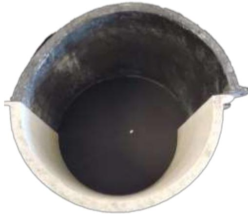
Figura 3.31 - Diferença nas dimensões dos moldes devido às pressões da reação química.
