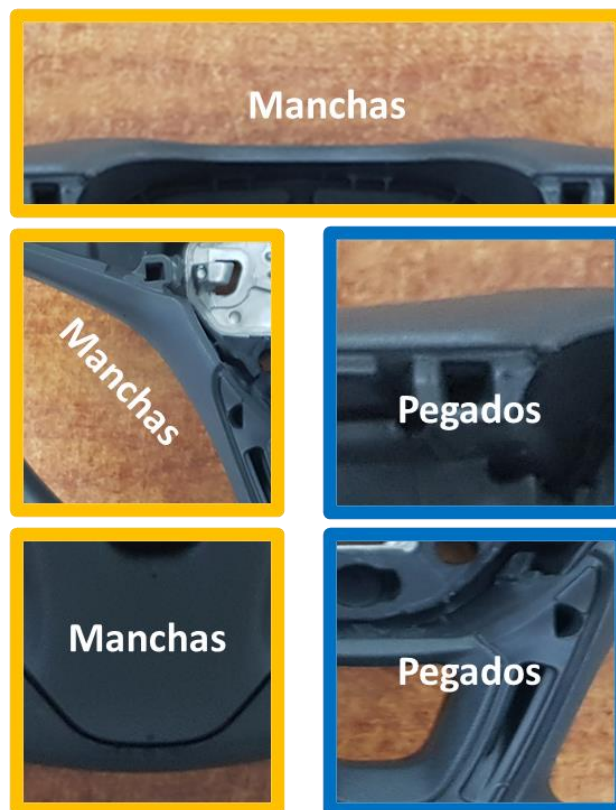
Figura 20: Zonas mais frequentes a defeitos de pegados e manchas de desmoldante, nos modelos Moderado. Adaptação própria.
