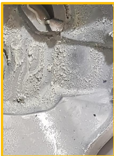
(a) Molde de injeção antes da limpeza.
