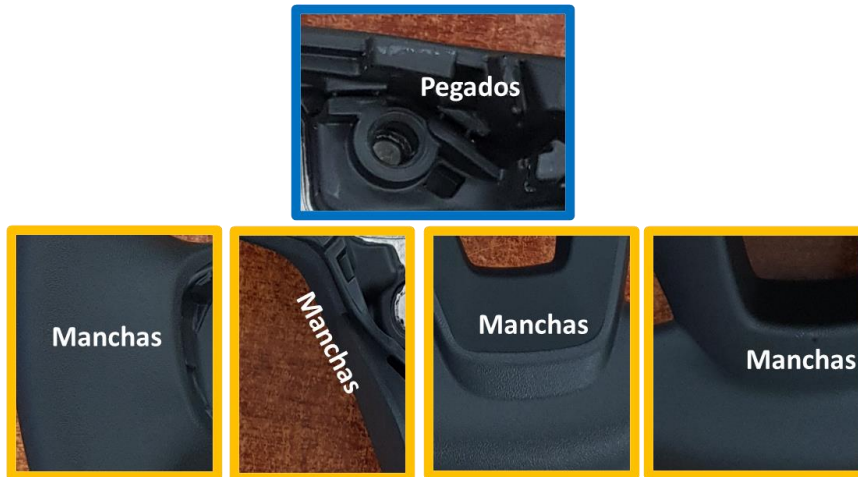
Figura 18: Zonas mais frequentes a defeitos de pegados e manchas de desmoldante, nos modelos Complexo. Adaptação própria.
