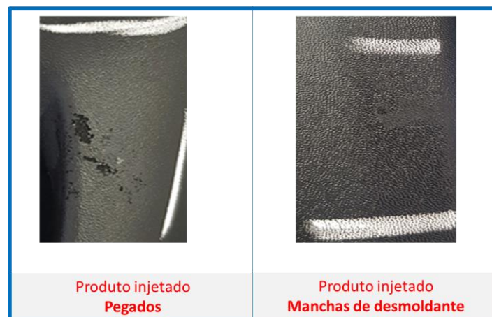
Figura 9: Exemplos tipos de produtos injetados com defeito de pegado e mancha de desmoldante. Adaptação própria.
