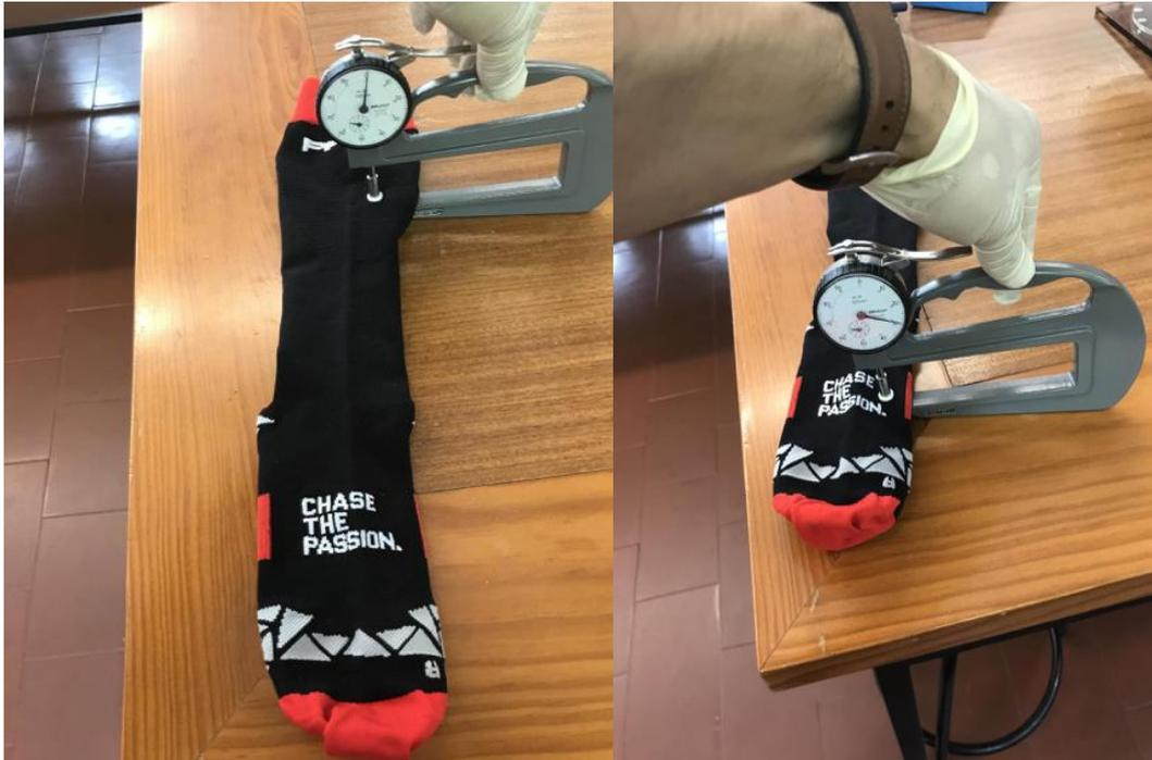
Figura 3. 2. Medição da espessura em camada dupla com equipamento Digital Thickness Gauge (Fotos do autor).
