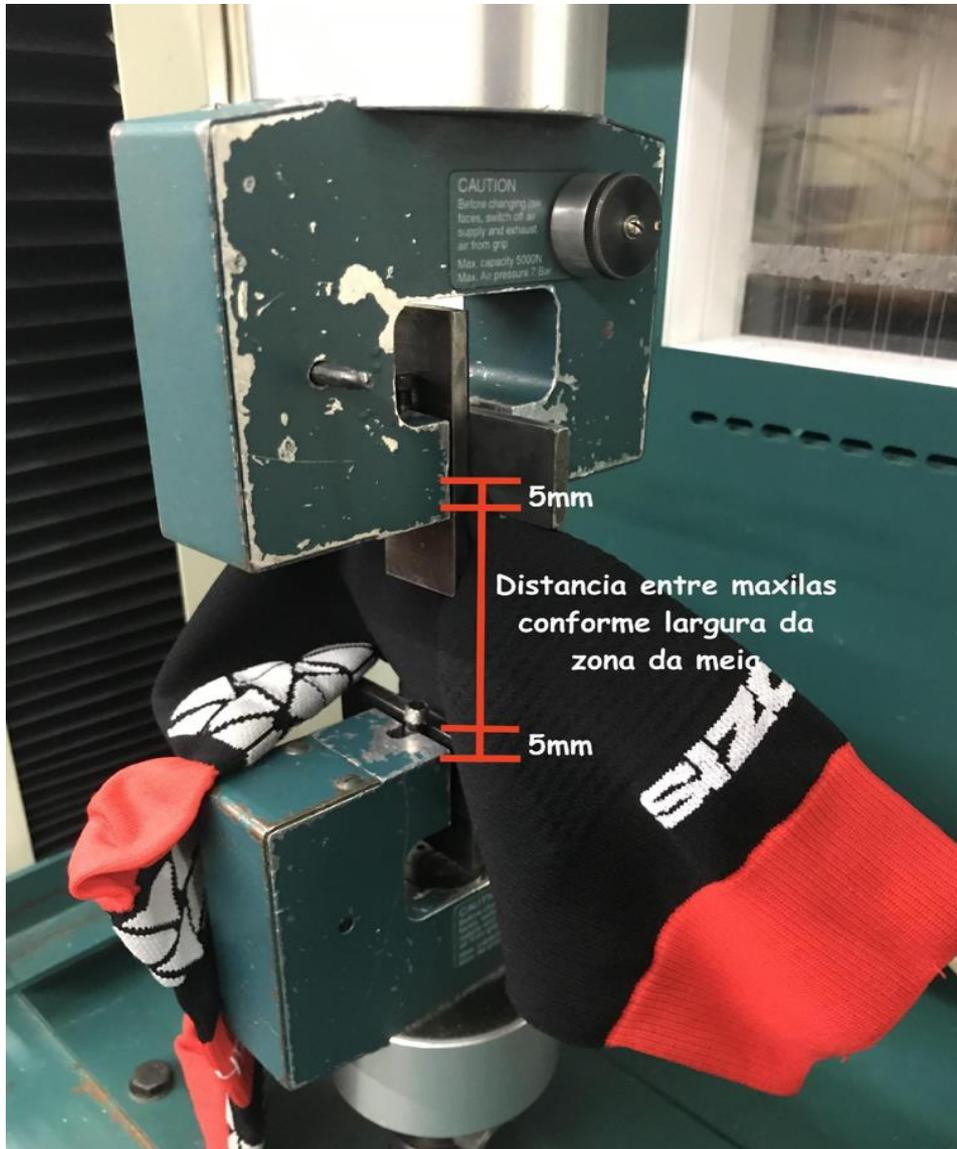
Figura 3. 4. Meia colocada entre as maxilas no dinamómetro (Foto do autor).
