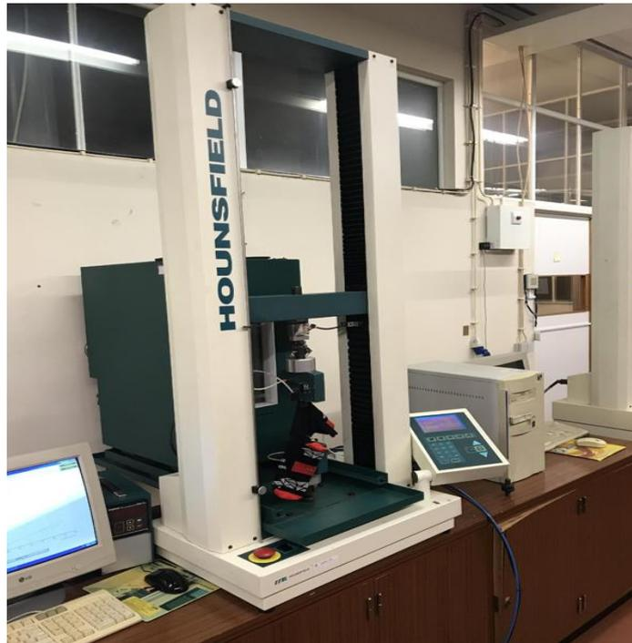
Figura 3. 3. Equipamento Dinamómetro Hounsfield (Fotos do autor).
