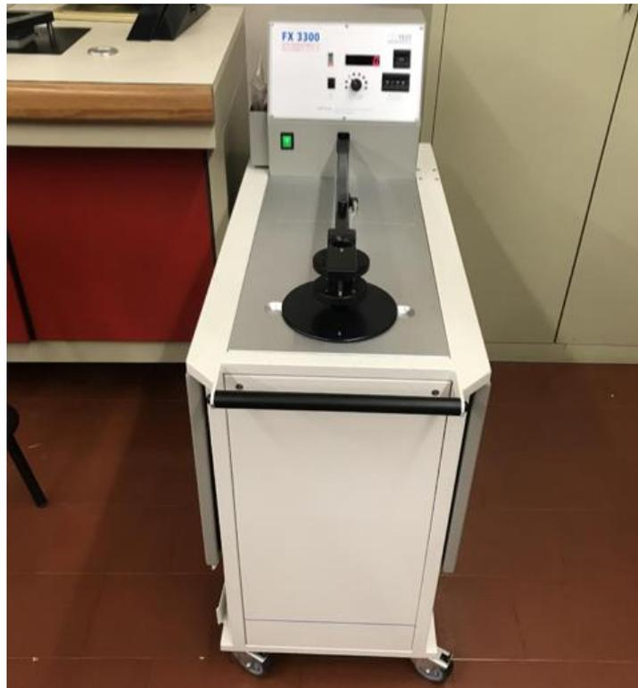
**Figura 3. 5.** Equipamento *Textest Instruments FX3300* utilizado para medição da permeabilidade ao ar.
