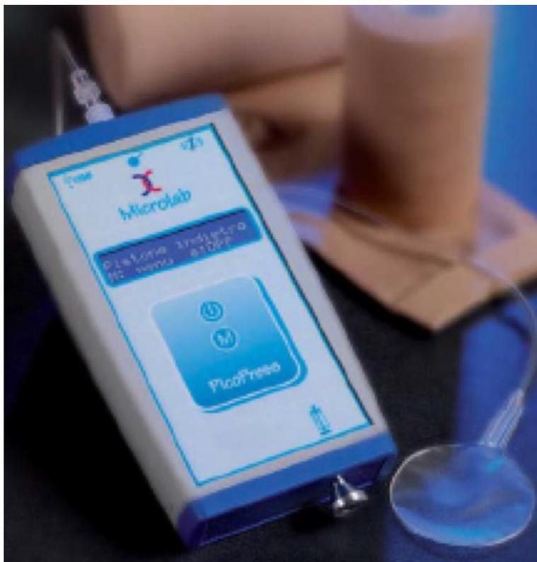
**Figura 3. 7.** Equipamento Picopress utilizado para medição da compressão (fonte: <https://www.vipmedikal.com.tr/wp-content/uploads/2016/02/PicoPress.pdf>).
