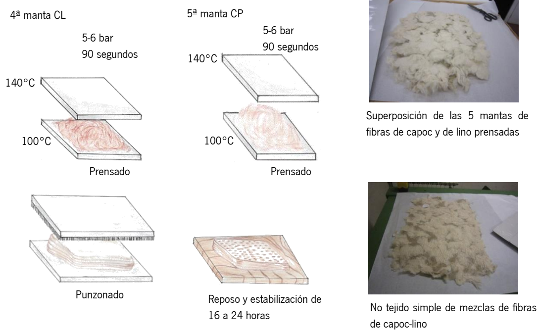
Figura 46. No tejido simple de mezclas de fibras de capoc-lino producido por el nuevo método de producción
