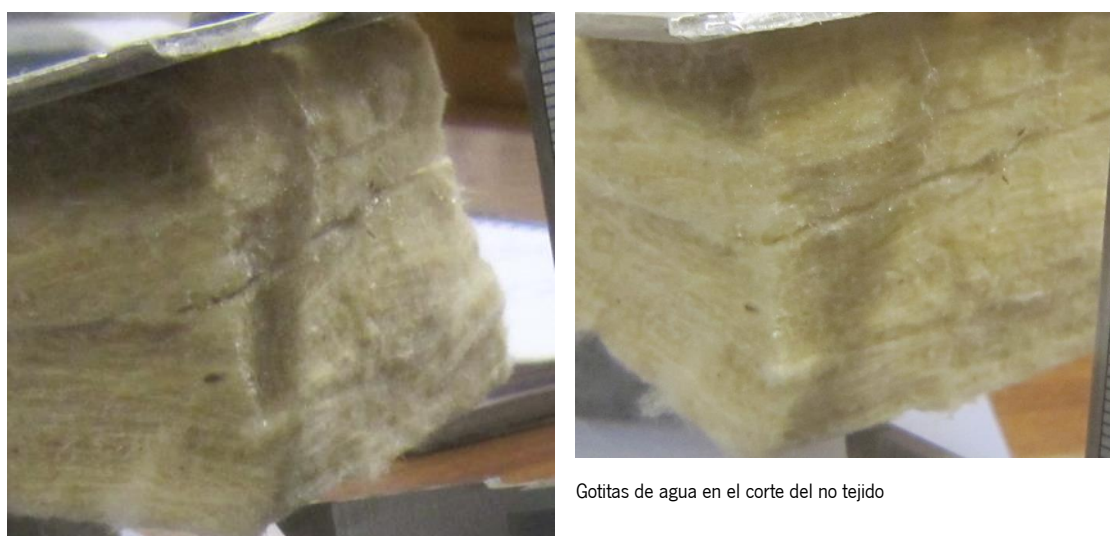
Figura 100. Gotitas de agua en el corte del no tejido después de la degradación en el QUV (12h de condensación)
