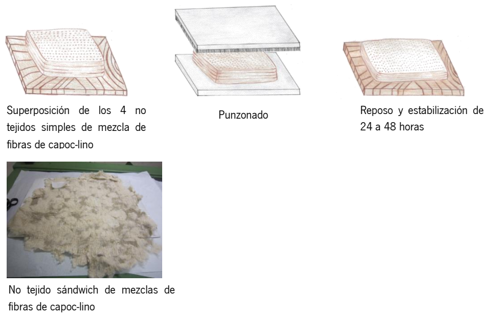
Figura 47. No tejido sándwich de mezclas de fibras de capoc-lino producido por nuevo método de producción
