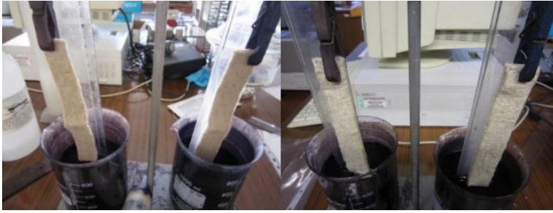
Figura 25. Test de capilaridad vertical de los tejidos de mezclas de fibras de CP-CL
