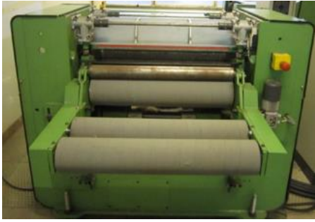
Figura 6. Equipo de punzonado convencional (parte de una línea de laboratorio de no tejidos Automatex)
