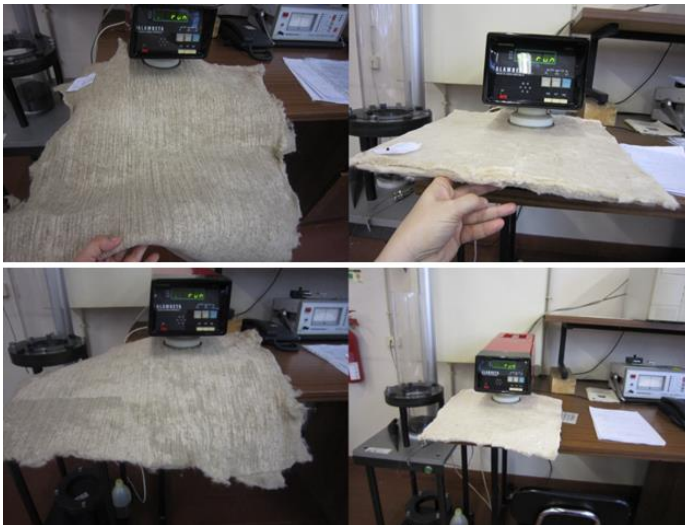
Figura 24. Evaluación de las propiedades térmicas de los no tejidos sándwich de mezclas de capoc-lino (izquierda) y de los no tejidos compuestos 100 % capoc (derecha) con el instrumento Alambeta
