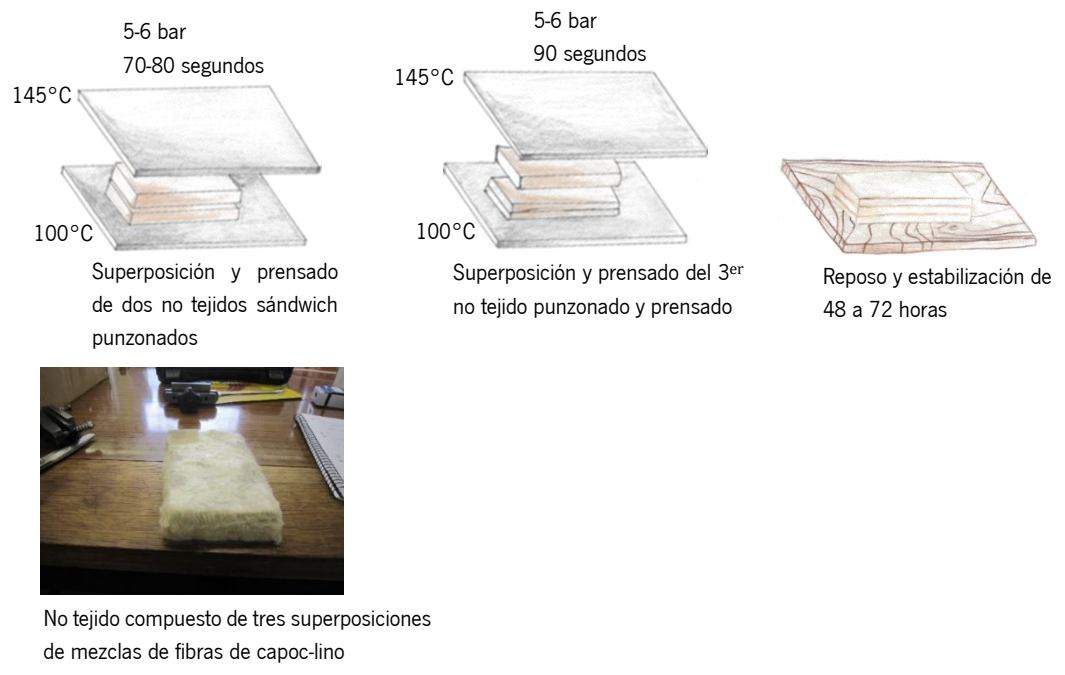
Figura 49. No tejido compuesto de mezclas de fibras de capoc-lino producido por el nuevo método de producción
