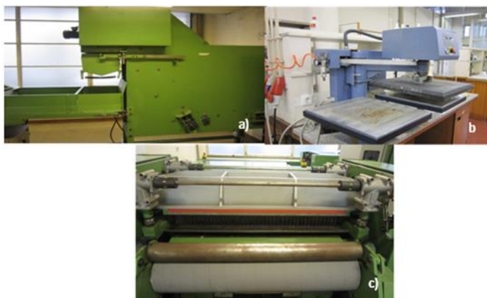
Figura 17. Método de obtención de estructuras a base de fibras de capoc: a) Abridora, b) Prensa, c) Punzonadora
