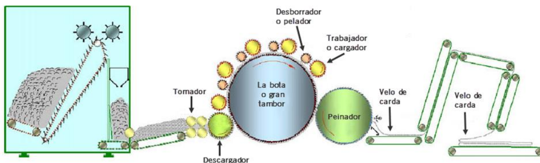
Figura 5. Diagrama del proceso de la formación de la manta de carda de un no tejido [39]
