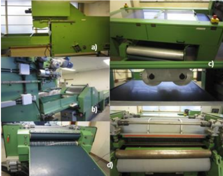
Figura 14. Línea Automatex: a) Abridora, b) Carda, c) Cross-Lapper, d) Punzonadora
