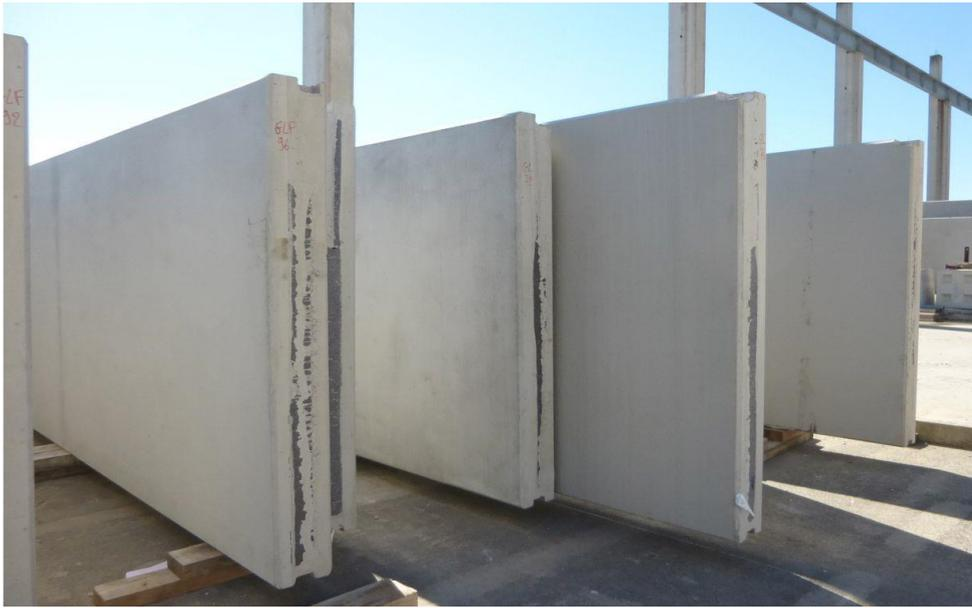
Figura 84: Painéis de betão pré-fabricado
