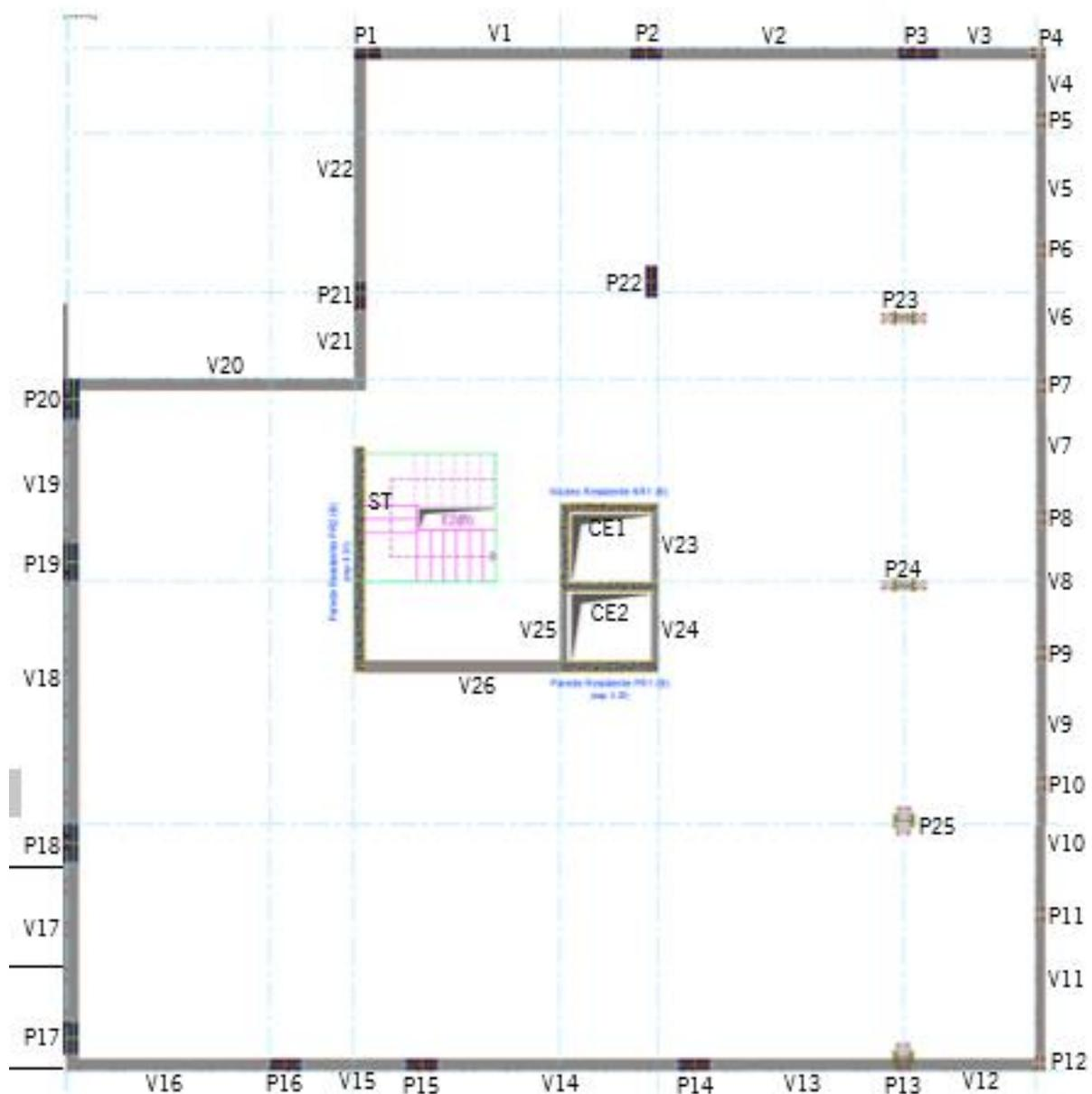
Figura 126: Numeração das vigas, pilares, caixas de elevadores e caixa de escadas
