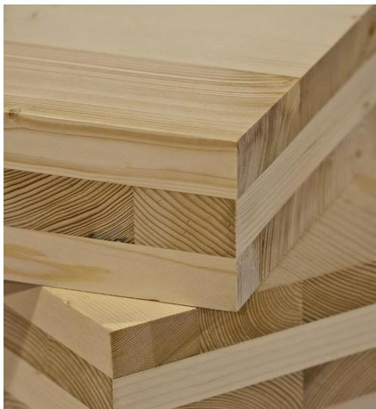
Figura 75: Painéis de madeira CLT
