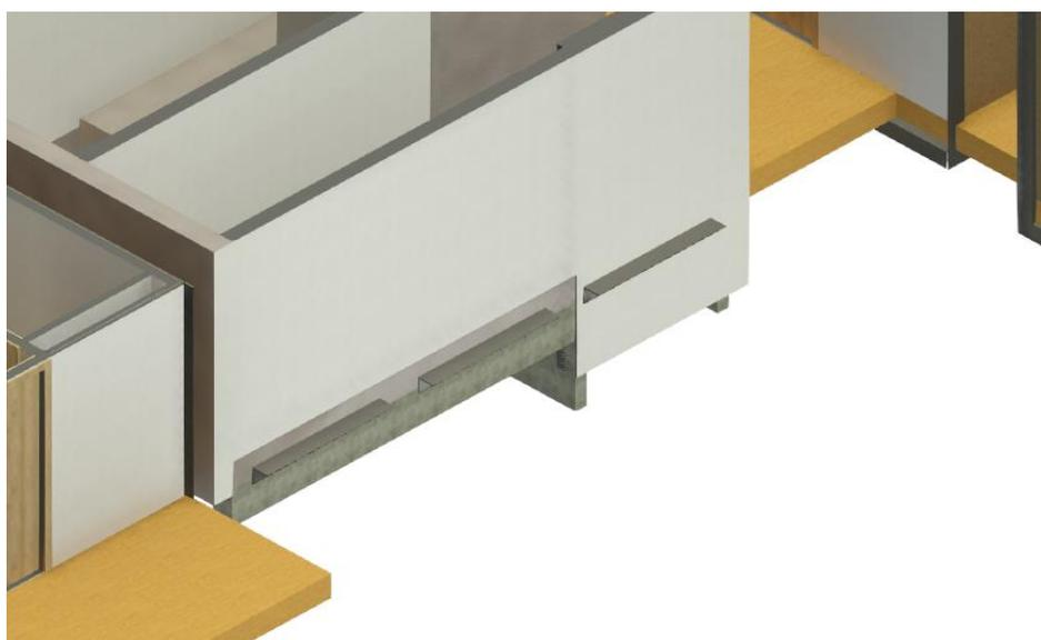
Figura 187: Cantoneiras chumbadas na viga e parede resistente
