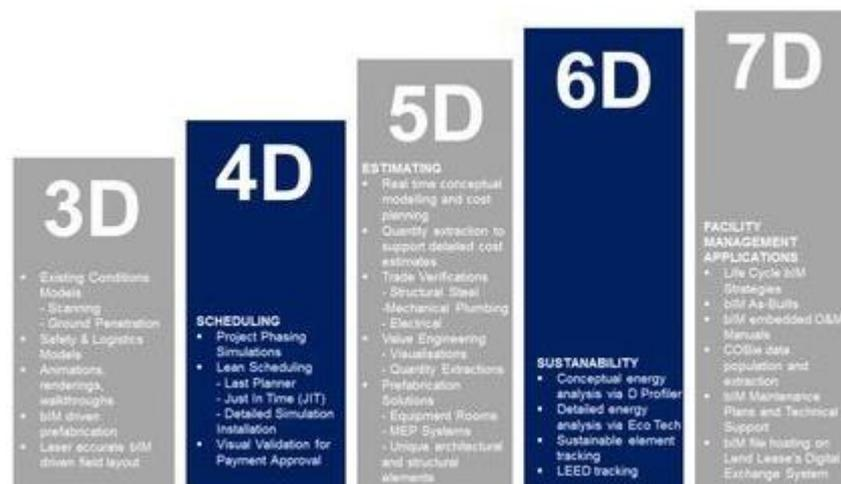
Figura 111: Diversas dimensões do BIM
