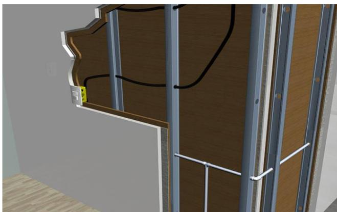
Figura 170: Esquemática dos constituintes da parede de gesso cartonado
