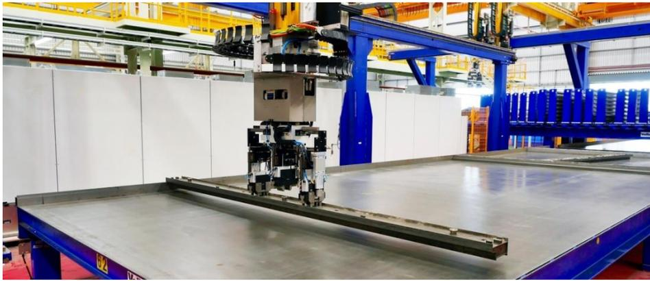
Figura 60: Molde para fabrico de peças em betão
