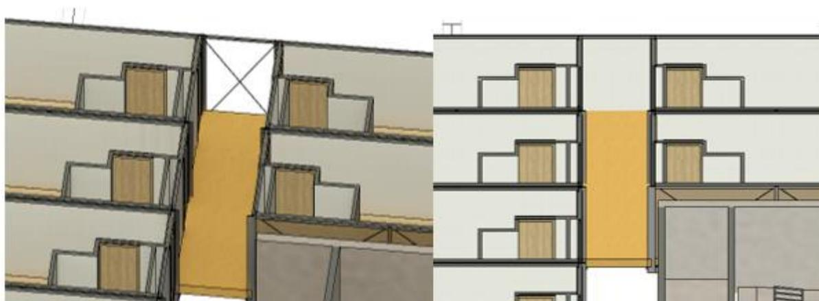
Figura 189: Execução da parede de fachada e assemblagem da laje de corredor
