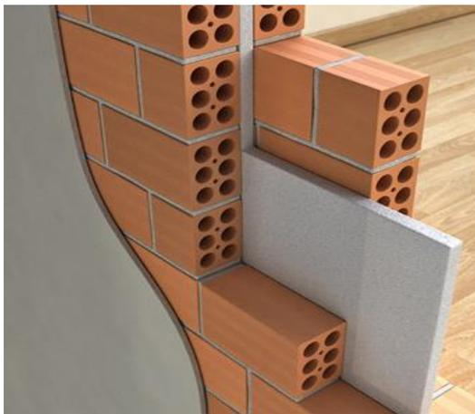
Figura 27: Parede de alvenaria dupla com isolamento
