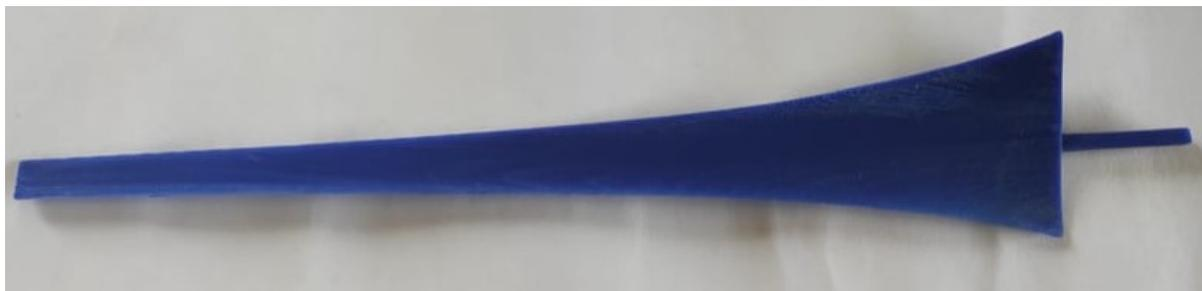
Figura 5.15 - Intradorso da pá obtida através da impressão 3D.
