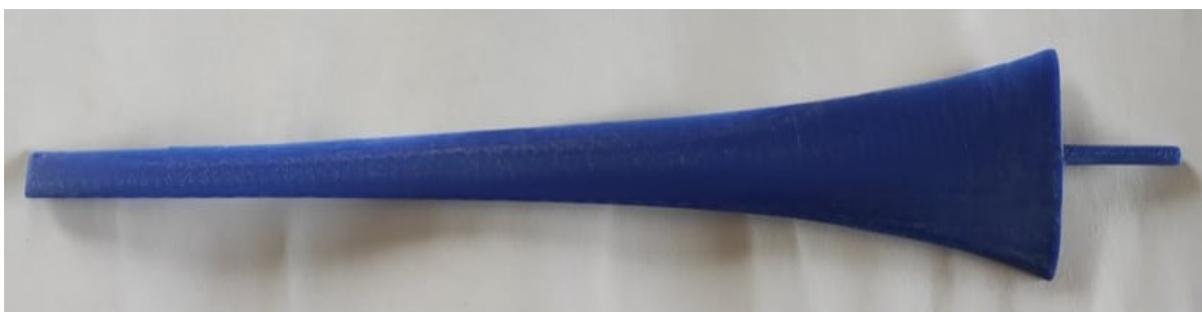
Figura 5.16 - Figura 5.15 - Extradorso da pá obtida através da impressão 3D
