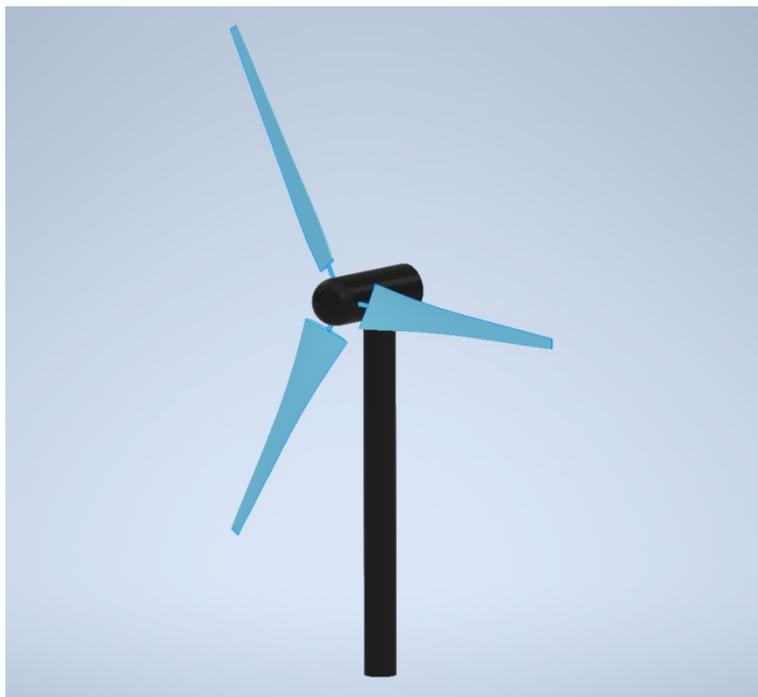
Figura 4.24 - Modelação completa do rotor e das pás.
