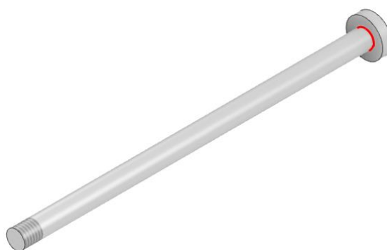
Figura 6-14 – Roscagem e soldadura no pino da dobradiça da porta de segurança.
