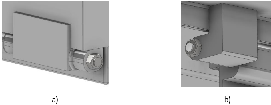
Figura 6-26 – Fixação dos pinos das dobradiças dos alçapões do contentor e das portas de segurança, respectivamente em a) e b).
