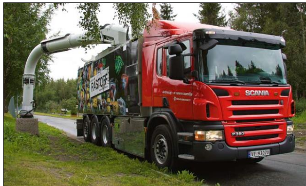
Figura 2-21 – Camião de recolha pneumático “Movac” [34].
