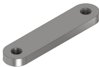
Figura 6-19 – Perfil da barra de transmissão de movimento após corte a laser.
