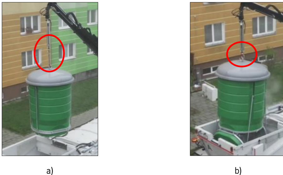
Figura 2-25 – Posicionamento dos elementos mecânicos com alçapões fechados e abertos, respetivamente em a) e b) [42].
