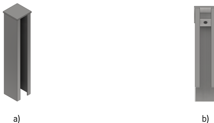
Figura 4-14 – Perspetiva isométrica e vista angular inferior do tubo fixador da corrente, respetivamente em a) e b).
