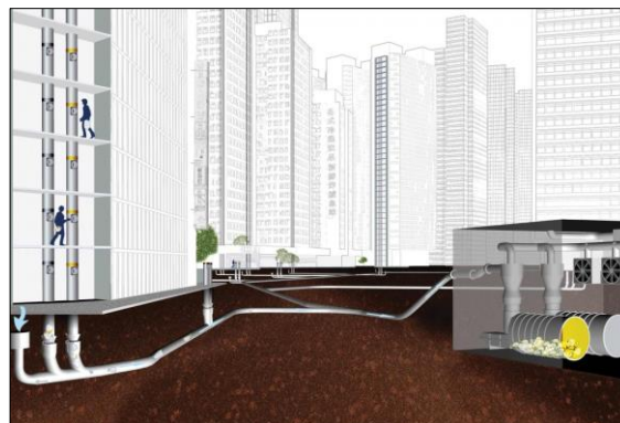
Figura 2-20 – Infraestrutura do sistema de recolha pneumática.
