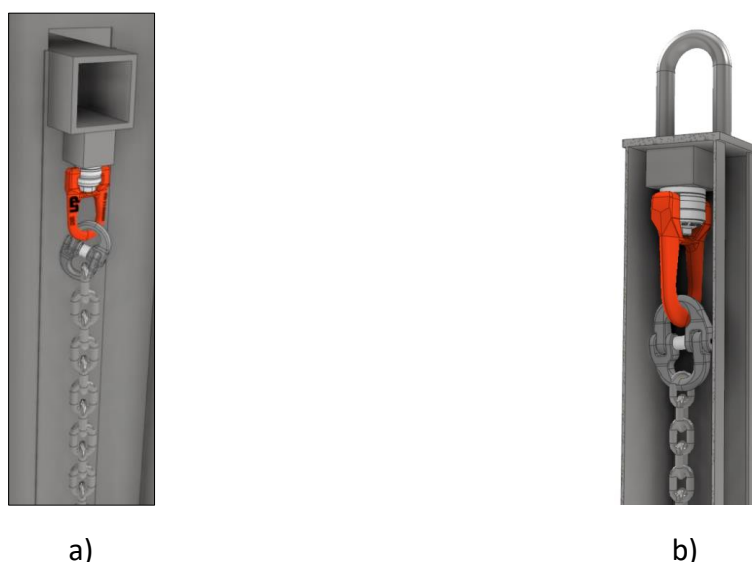
Figura 6-29 – Subconjuntos das correntes, dos elos de ligação e dos anéis de elevação para a secção do perfil de engate das correntes/alçapão do contentor e tubo fixador da corrente/perfil de engate das correntes, respetivamente em a) e b).
