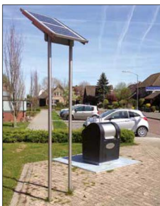
Figura 2-18 – Marco de deposição e respetivo painel solar responsável pela alimentação da prensa [19].
