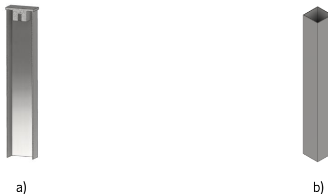
Figura 4-15 – Vista em corte do tubo fixador da corrente e tubo para passagem da corrente, respetivamente em a) e b).
