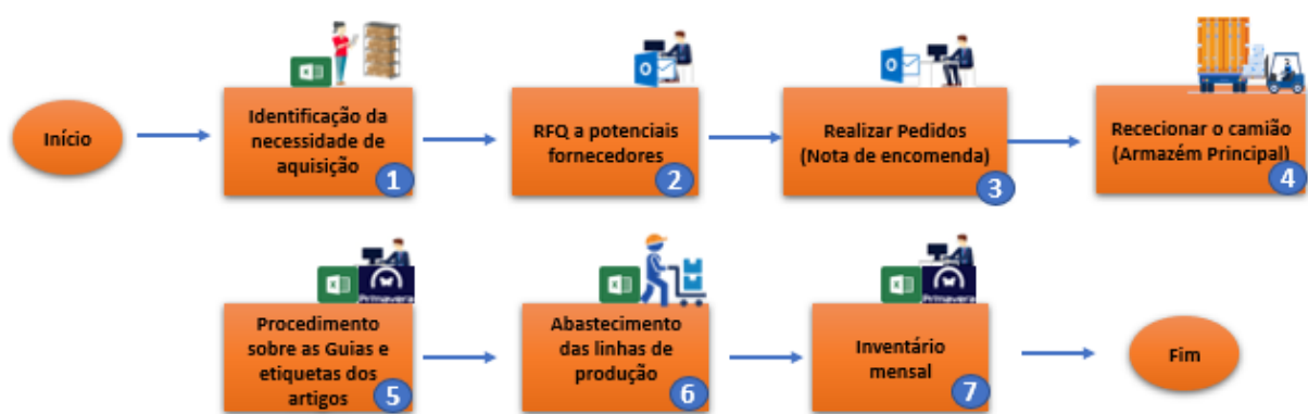
Figura 28 - Etapas do processo de aprovisionamento de Bobines em Chapa Metálica
