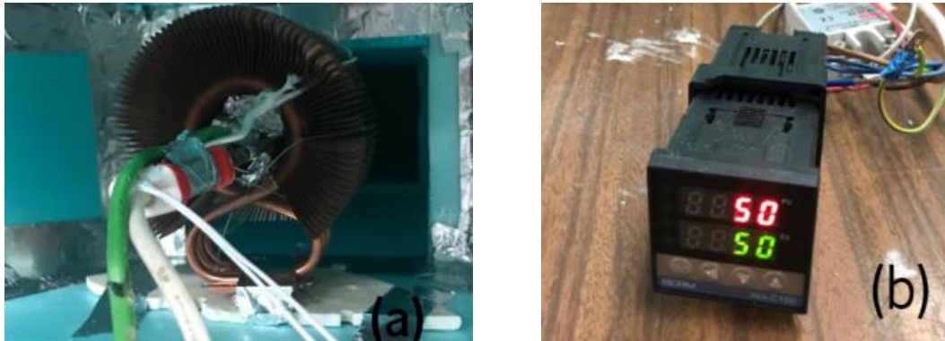
Figura 5.13 – (a) Fonte de calor e dissipador; (b) Regulador de temperatura
