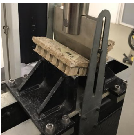
Figura 5.11 – Momento de rotura da placa
