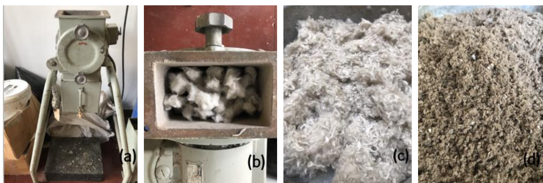
Figura 5.6 – (a), (b) moinho de lâminas; (c) Resíduo têxtil triturado; (d) Resíduo de papel triturado
