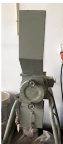
Figura 4.1 – Moinho de lâminas (Laboratório de Materiais de Construção, Universidade do Minho)
