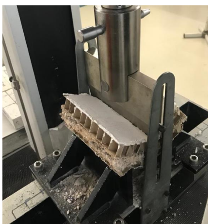
Figura 6.8 – Realização ensaio à flexão P11S - SANDWICH
