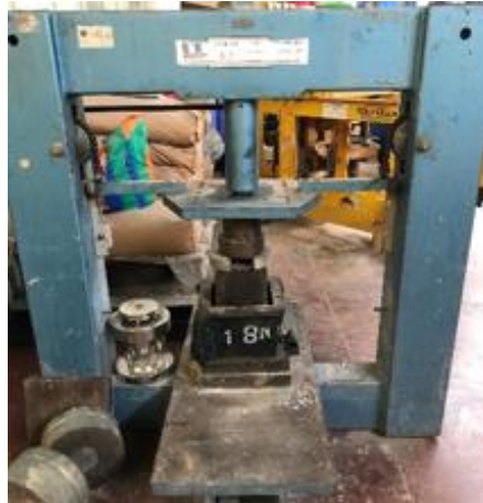
Figura 5.3 – Compactação realizada no equipamento ELE
