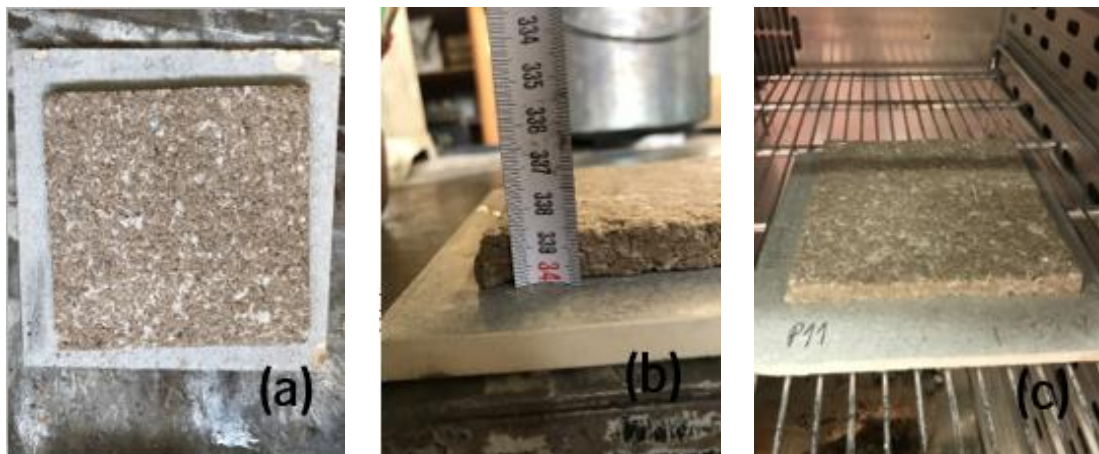
Figura 5.4 – (a) e (b) Placa após desmoldagem; (c) Armazenamento em estufa
