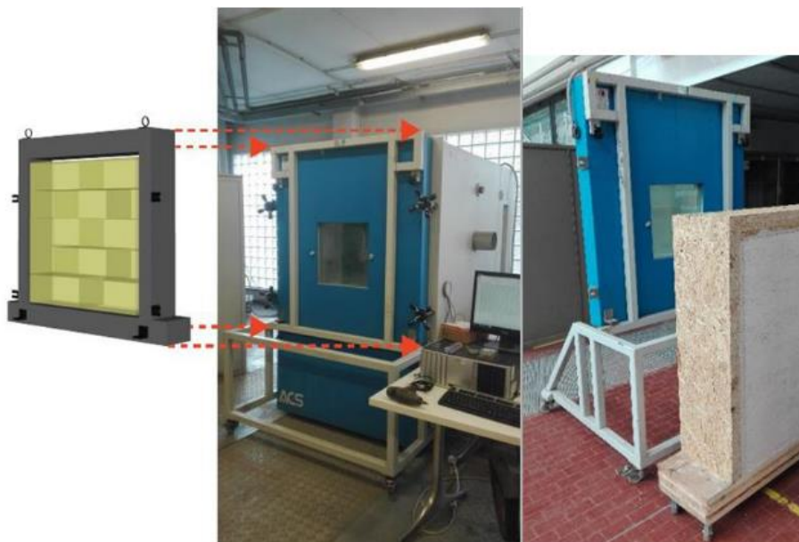
Figura 10 - Aplicação da parede de betão de cânhamo na câmara climática [33].
