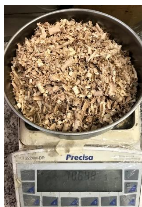
Figura 16 - Pesagem do material utilizado no ensaio de peneiração.
