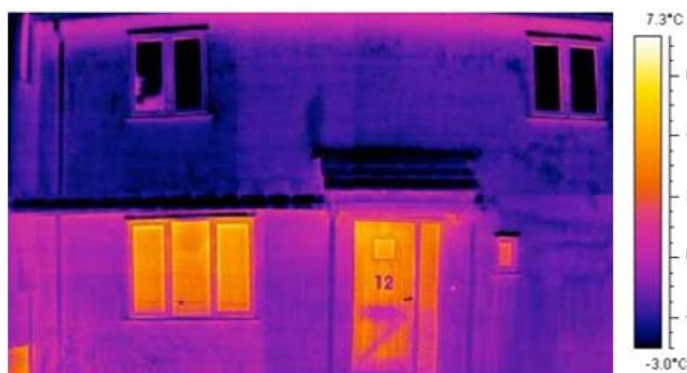
Figura 14 - Imagem termográfica da casa em cânhamo com escala de temperatura [34].
