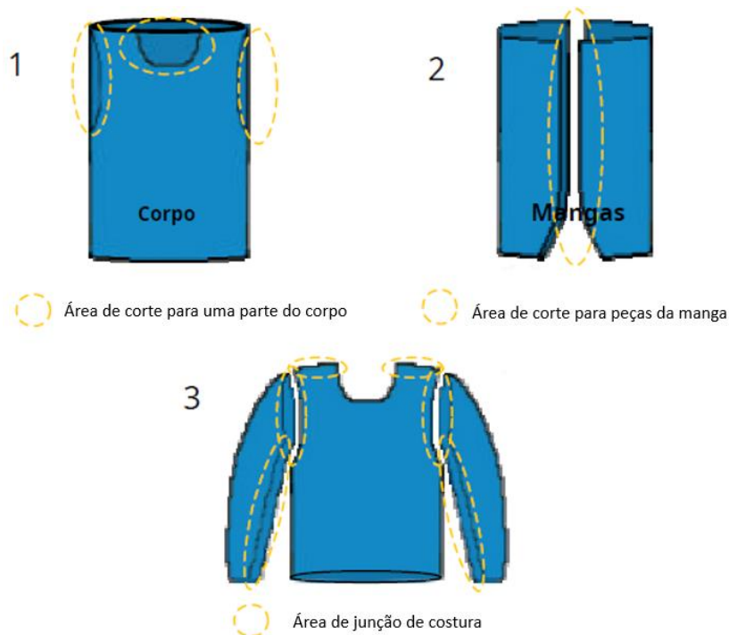
Figura 4. Produção de tubos para vestuário sem costura por uma máquina de tricotagem circular. Adaptado de Chio & Powell, (2005).
