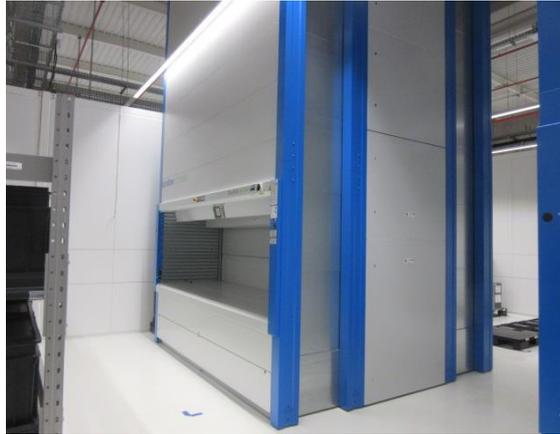
Figura 22 - Sistema automatizado- *kardex*
