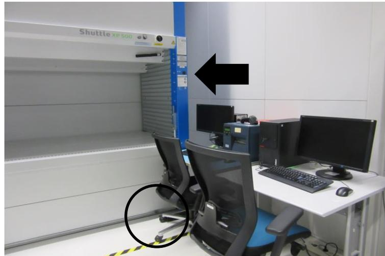
Figura 42 - Posto de trabalho a impedir o funcionamento do Kardex
