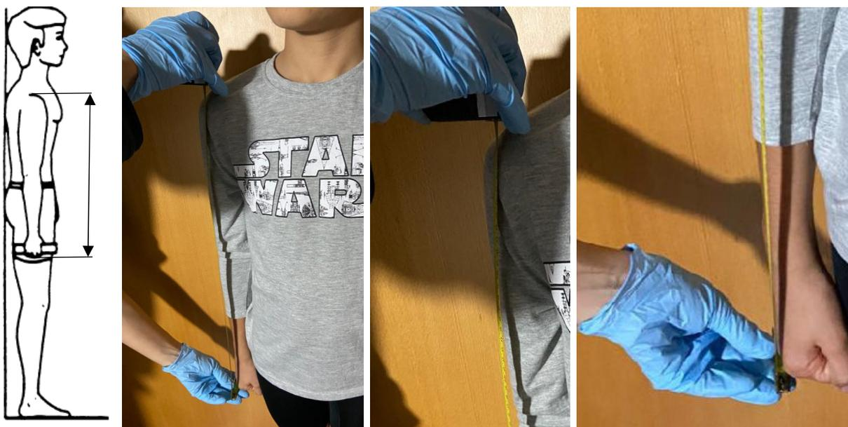
Figura 16 – Medição do comprimento do braço: a) Esquema (ISO, 2008); b) Fotografias da medição
