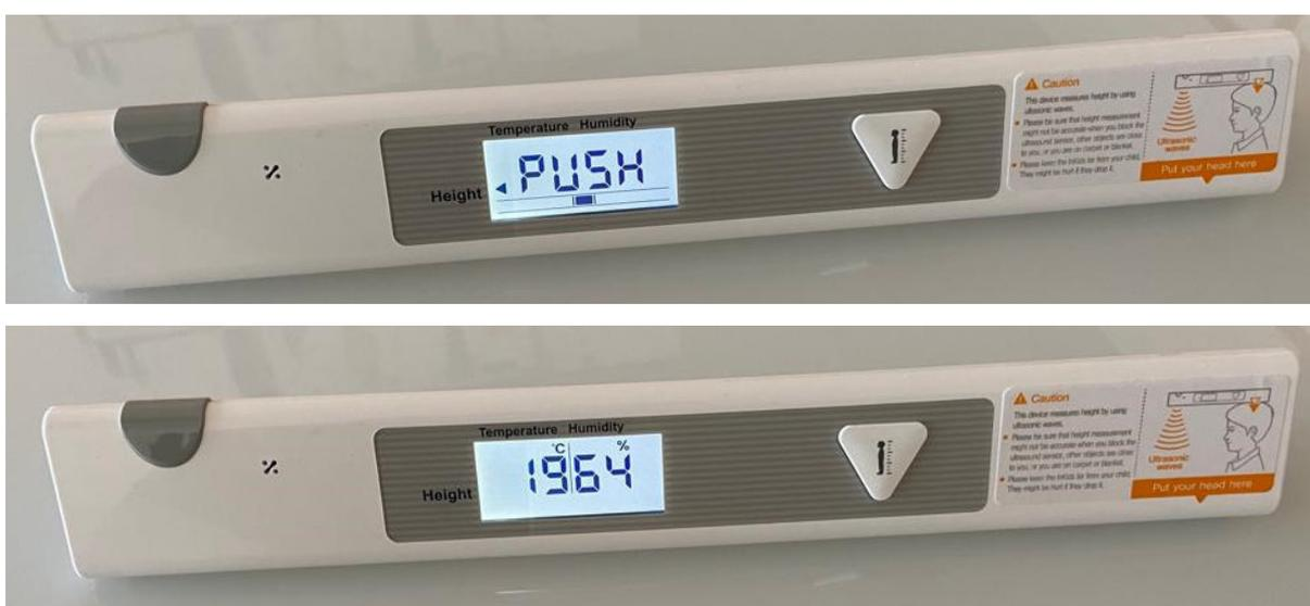
Figura 4 – Estadiômetro *InLab S50*: a) indicação de acionamento; b) apresentação de medição
