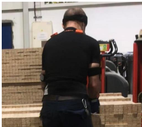
Figura 11 - Colaborador equipado com os sensores, com o sistema XSens.
