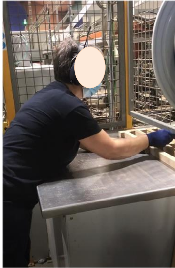
Figura 9 - Operadora a retirar manualmente as ripas duplas da linha 2 da pré-Master Frame.
