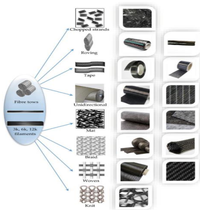
Figura 2 – Esquema representativo da diferente organização e apresentação das fibras[10].
