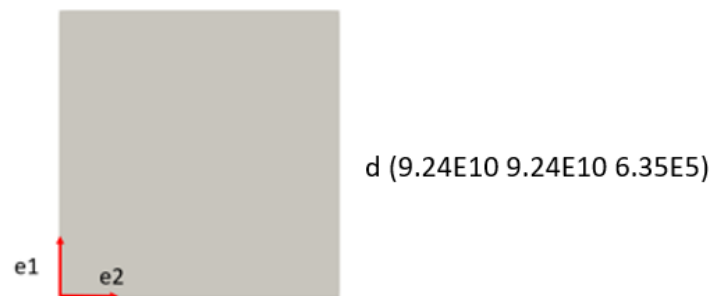
Figura 16 – Definição da permeabilidade da placa representativa da Guitarra.
