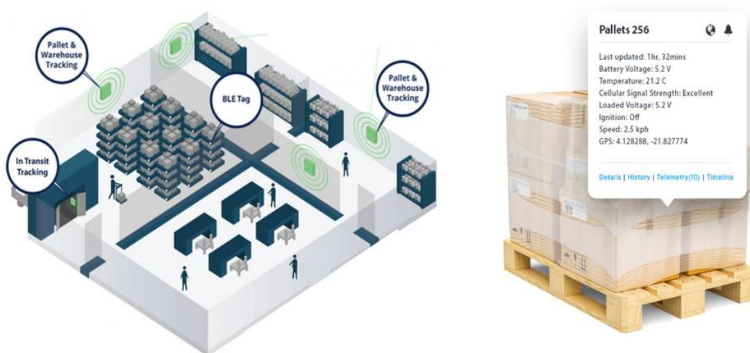
Figura 1 - Esquema de tracking de paletes dentro de um armazém (esquerda). Exemplo de informação de uma paleta (direita).
