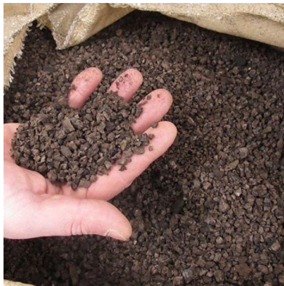
Figura 24: Granulado de cortiça expandida fornecido pela corticeira Amorim. Fonte: Declaração ambiental de produto, Corticeira Amorim (2016).
