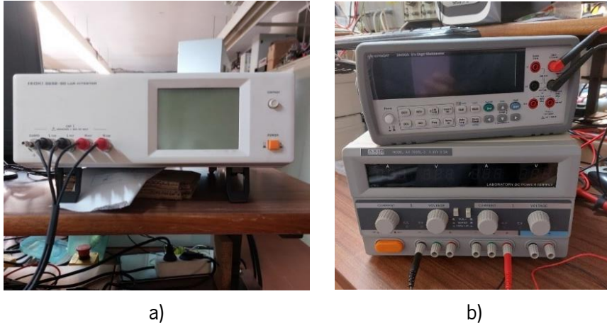
Figura 32 - Aparelhos utilizados para as medições da condutibilidade: a) Hi Tester, b) multímetro digital e fonte dupla
