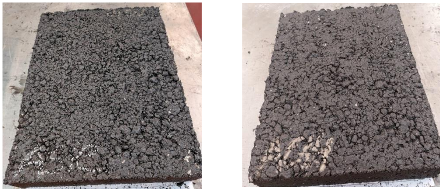
Figura 38 - Lajes da mistura de ASIC e AC14 com grafite
