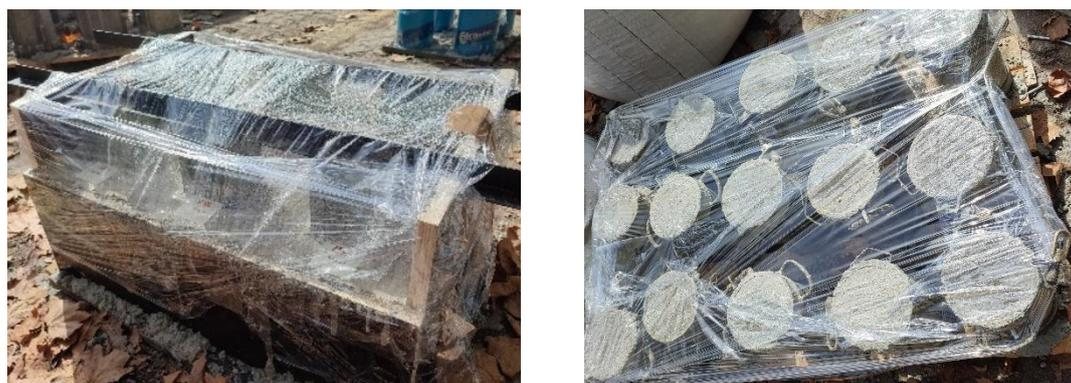
Figura 4.14 Provetes selados com filme estirável.
