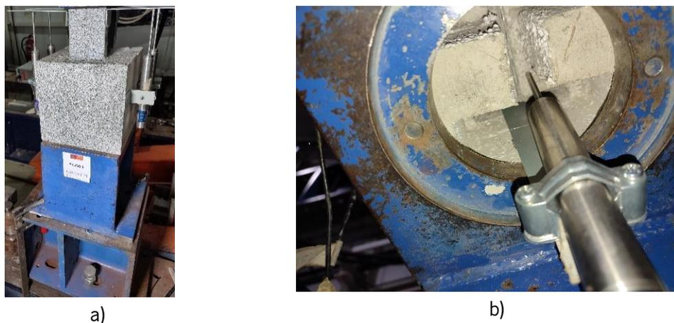
Figura 5.4 Sistema de apoio utilizado nos ensaios experimentais: a) Elementos utilizados; b) Abertura circular existente na face do apoio.
