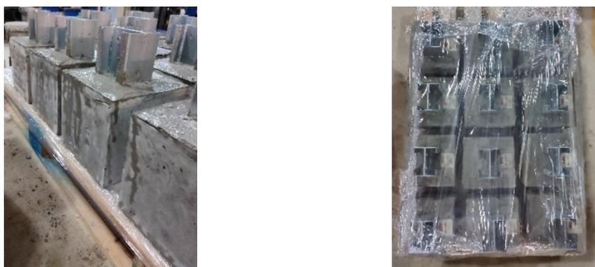
Figura 4.16 Humedecimento e selagem dos provetes *push-out* após a descofragem.
