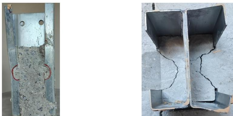
Figura 5.13 Instabilidade distorcional ocorrida de maneira muito acentuada no perfil metálico do provete P- B.1-2.
