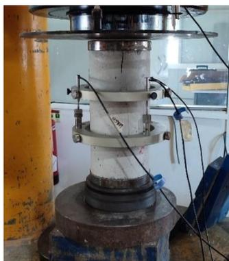
Figura 4.21 Ensaio experimental do módulo de elasticidade.
