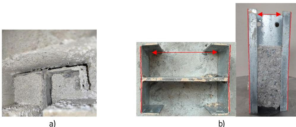
Figura 5.8 Aspectos do comportamento geral dos provetes: a) Desprendimento de betão na zona inferior em provetes do tipo P-L; b) Instabilidade ocorrida no perfil metálico.
