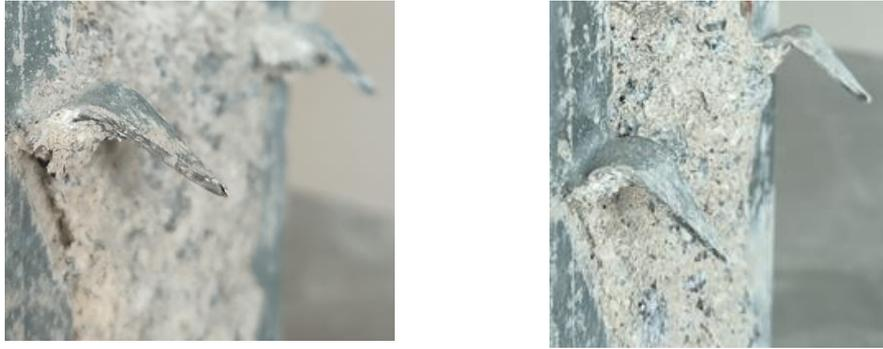
Figura 5.19 Condição dos conectores dos provetes P- C.1 após o ensaio.
