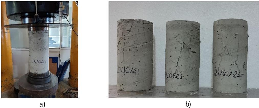
Figura 4.18 Ensaio de resistência á compressão: a) Decorrer do ensaio; b) Provetes após rotura.
