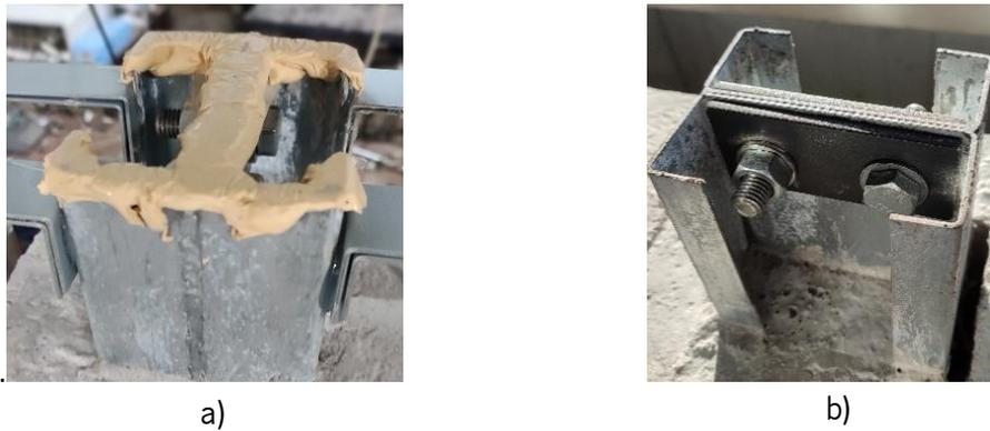
Figura 5.3 Perfil metálico no ensaio experimental: a) Utilização de massa de ferro; b) Chapas de reforço na alma do perfil metálico.
