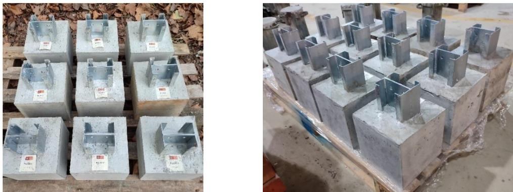
Figura 4.15 Provetes *push-out* após a descofragem.
