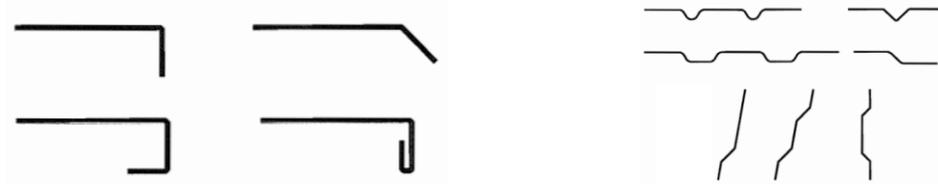
Figura 2.6 Reforços (*stiffeners*): a) reforços intermédios; b) reforços intermédios. (EN 1993-1-3, 2006).
