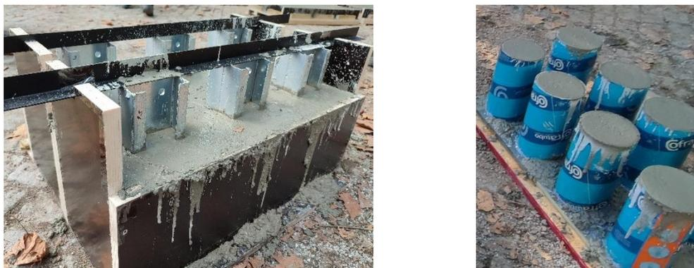
Figura 4.13 Betonagem dos provetes *push-out* e provetes cilíndricos.
