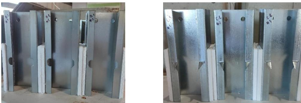
Figura 4.9 Colagem do EPS aos perfis metálicos.
