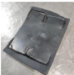
Figura 5.9 Borracha usada no ensaio do provete P-L150-1.
