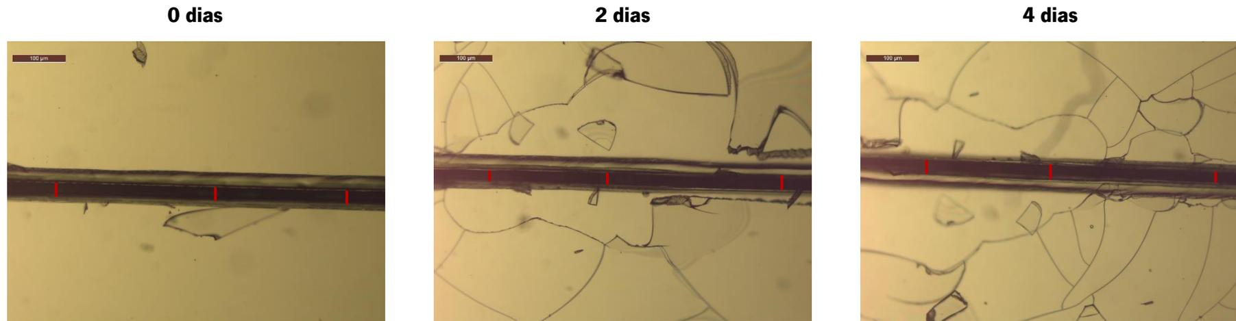
Figura 43 - Avaliação superficial do processo de regeneração e identificação da espessura medida a vermelho ( $\mu\text{m}$ ) de um corte introduzido em filmes de PU, obtidos a partir do PU2 (com agentes de *self-healing*) aplicado em PET, aos 0 dias (antes do estímulo térmico) e 2 e 4 dias após, através da técnica de microscopia ótica e com uma ampliação total de 100x.
