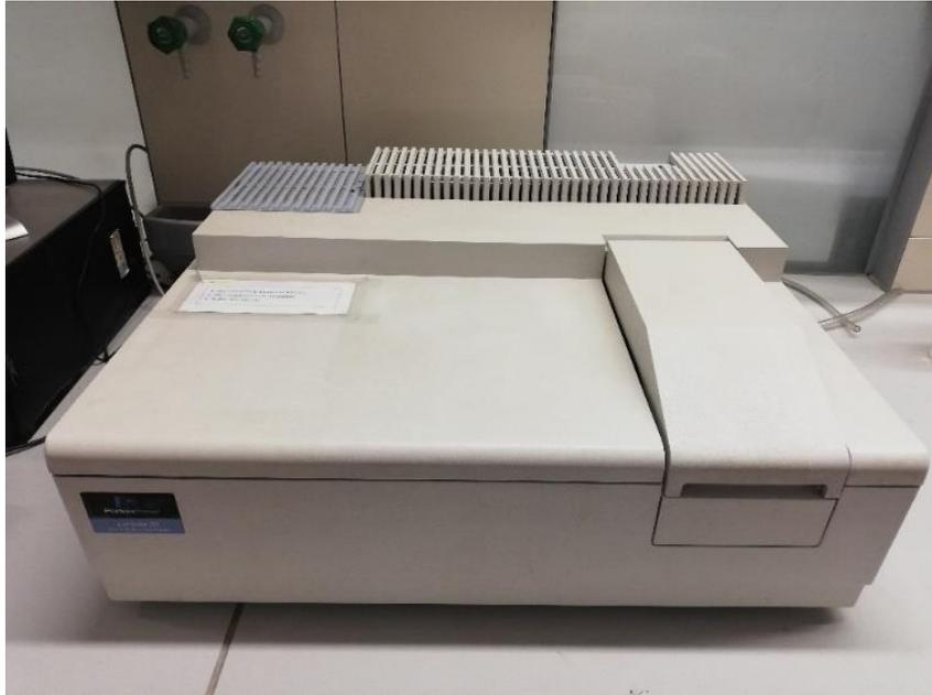
Figura 20 – Espectrofotômetro UV-Vis *Perkin Elmer* Lambda 35 de duplo feixe utilizado.
