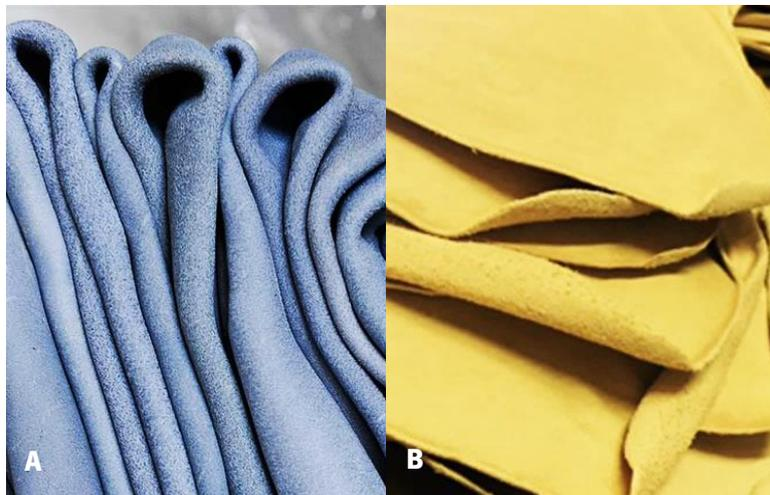
Figura 2 – Amostras de pele após o processo de curtume: Wet-blue (A) e Wet-white (B). Fonte: Chen Tong Leather Co (n.d.); Franco e Figli S.R.L. (n.d.) <sup>17,18</sup>.
