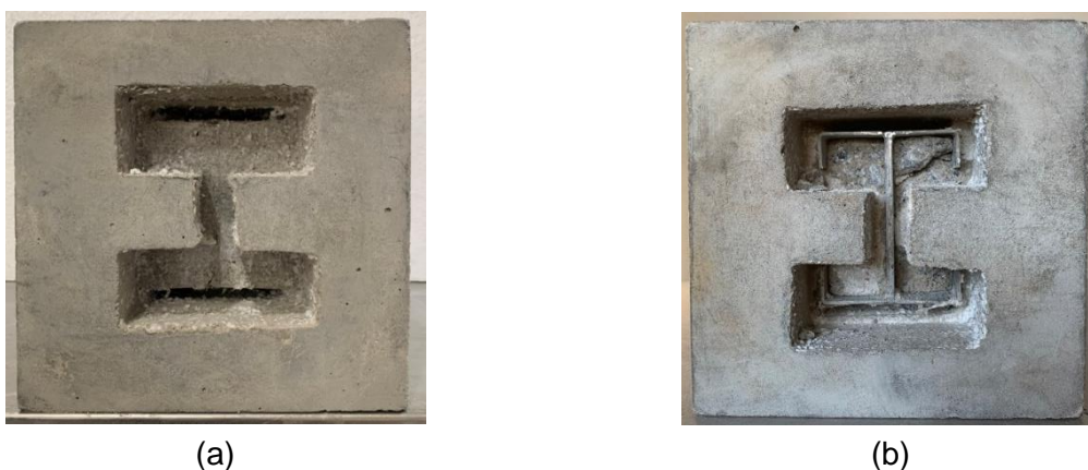
Figura 7. Parte inferior (área vazia) do provete P_L150_01: (a) antes do ensaio; (b) depois do ensaio.
