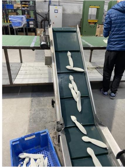
*Figura 11 - Representação dos pré-formatos retirados da barwell*
