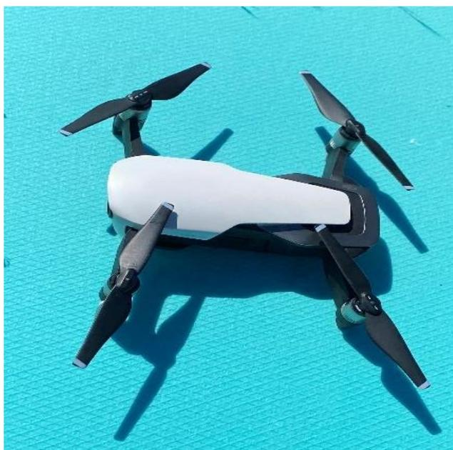
**Figura 29.** VANT utilizado para levantamento aerofotogramétrico
