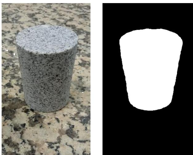
**Figura 25.** Provete de granito e a correspondente máscara
