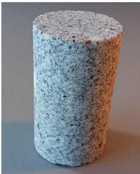
**Figura 24.** Provete de granito (base lisa)
