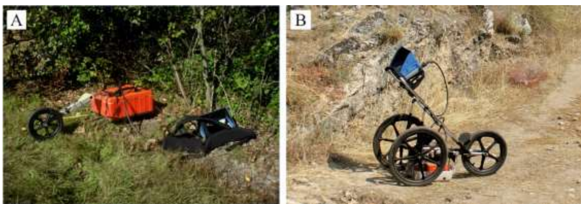
Figura 3.1 – Exemplos de uso do equipamento GPR em dois tipos de aparato com antenas diferentes, 200 MHz em A e de 400 MHz em B. Nesta dissertação o aparato usado foi o da situação A por ser mais simples e fácil.
