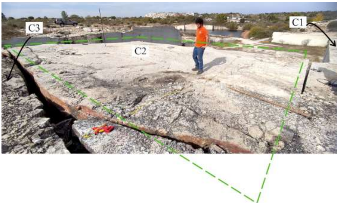
Figura v – Levantamento fotográfico das secções da área C em Malpartida (Almeida, Guarda), principalmente do bloco solto de como ele se encontrava em relação aos hasteais da área C1 e C3 (outubro, 2021).
