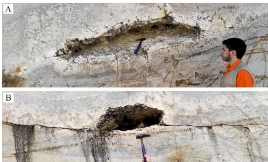
Figura 2.7 – Levantamento fotográfico das cavidades encontradas na pedreira de Malpartida (Almeida, Guarda) (julho, 2021).
