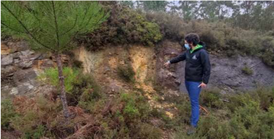
Figura 3.4 – Levantamento fotográfico de evidências do pegmatito clástico no talude do acesso (estrada de terra batida) (dezembro, 2021).
