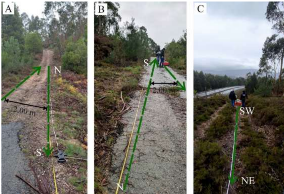
Figura 3.5 – Levantamento fotográfico da passagem do equipamento de GPR na secção 3 e 4 da área A (A e B) e da área B (C) pelas setas verdes (dezembro, 2021).
