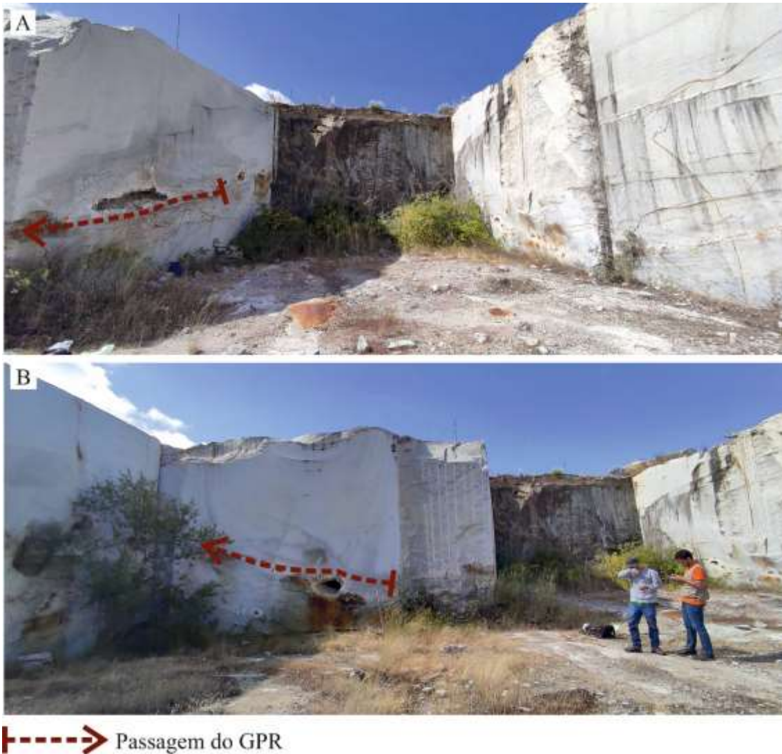
Figura 4.13 – Levantamento fotográfico do bloco solto com a indicação da passagem do GPR nos hasteais a N e W (julho, 2021). A: Hasteal W (N-S); B: Hasteal N (W-E).
