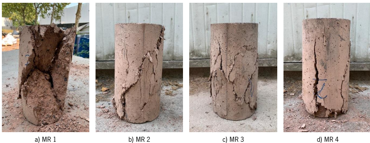
Figura 55 - Modos de rotura no ensaio de compressão
