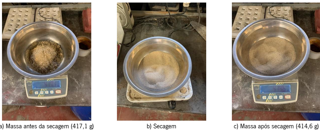
Figura 24 - Quantificação do teor de humidade dos agregados
