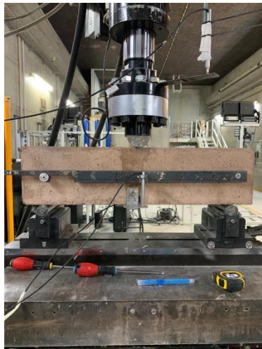
a) Posicionamento da viga
