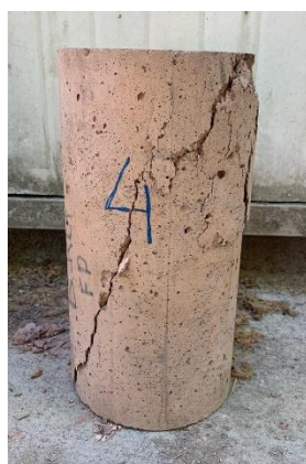
Figura 34 - Provetes com rotura inadequada (B_CER)
