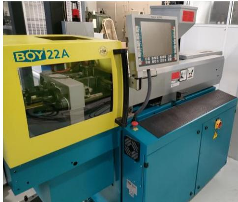
Figura 8: Máquina de Moldação por Injeção BOY 22A.
