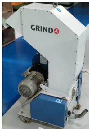
Figura 10: Granulador Grindo.
