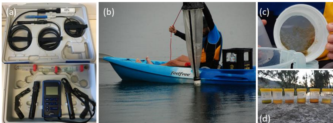
Figura 3.2 – (a) Sonda multiparamétrica e processo de amostragem in situ com (b) recolha de zooplâncton com rede de plâncton de 153 \mu\text{m} , (c) concentração da amostra com rede de 100 \mu\text{m} e (d) conservação da amostra em álcool a 70%.
