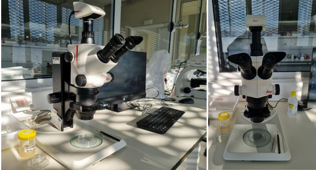
Figura 3.5 – Identificação e enumeração dos exemplares de zooplâncton à lupa com auxílio a uma câmara de contagem apropriada.
