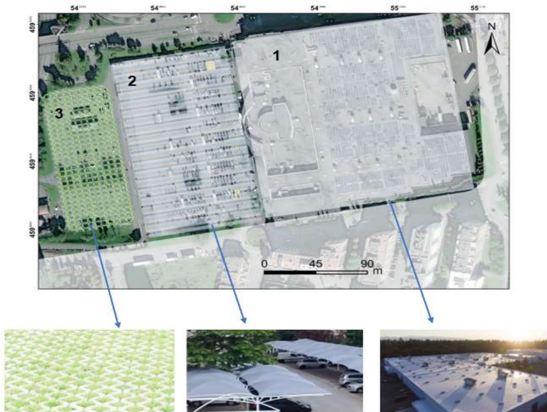
Figura 22 – Esboço do centro comercial Minho Center com as alterações com vista a mitigar o efeito de ilha de calor nesta região
