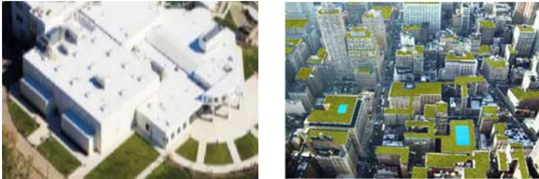
Figura 9 – Representação de um telhado fresco (imagem da esquerda, Pratap et al. , 2017) e de um telhado verde (imagem da direita, Shafique et al. , 2018)
