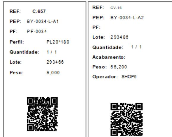
Figura 11 - À esquerda etiqueta tipo gerada para semi-acabado (Peça simples), à direita etiqueta tipo gerada para acabado (Conjunto)
