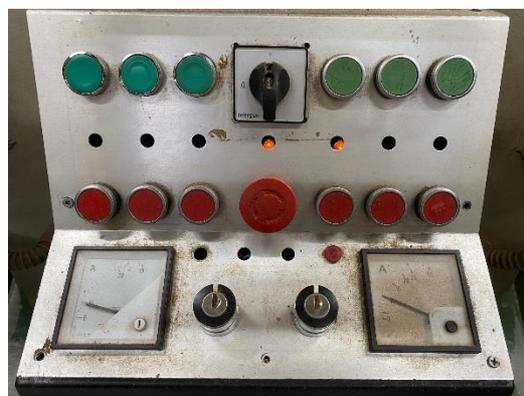
Figura 14 - Seletores de velocidade nas ponçadeiras e topejadeiras
