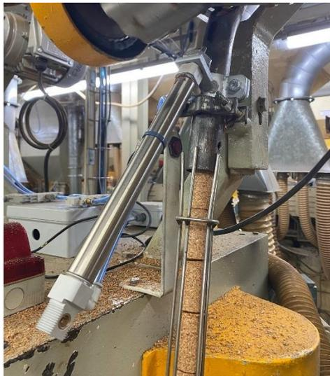
Figura 15 – Cilindro pneumático com temporizador
