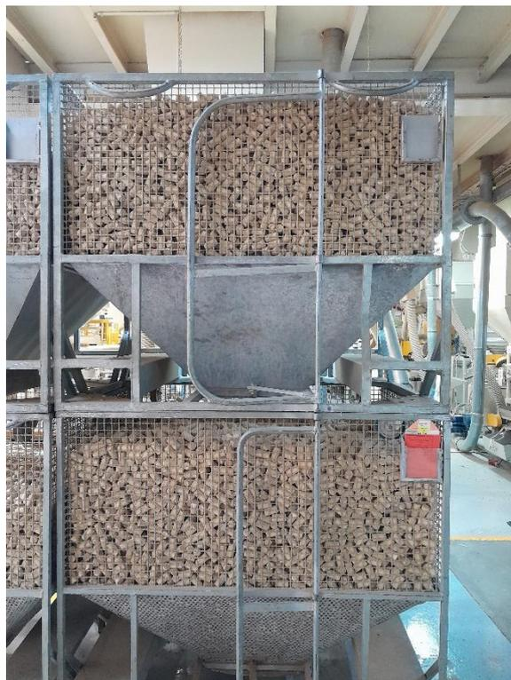
Figura 8 - Carro para armazenamento de rolhas
