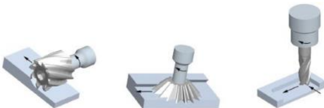
Figura 7- Fresagem cilíndrica (esquerda), fresagem de face (centro) e fresagem de topo (direita).
