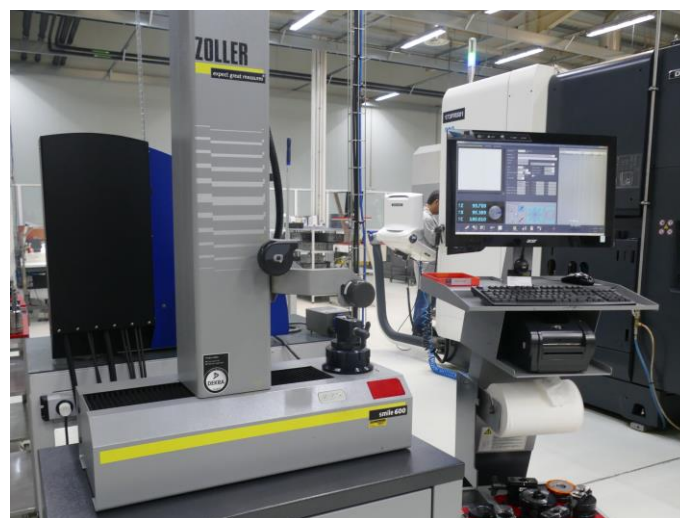
Figura 19- Máquina Zoller (medição de ferramentas).
