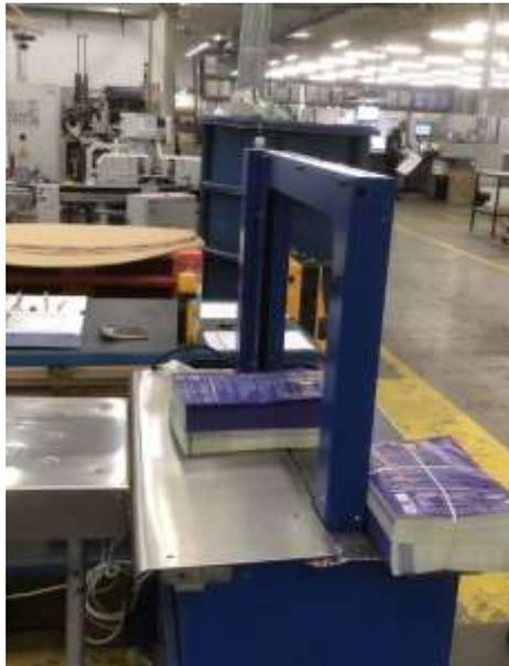
Figura 21 – Fixação dos maços de planos
