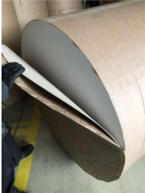
Figura 11 – Abertura da bobine por suspeita de dano
