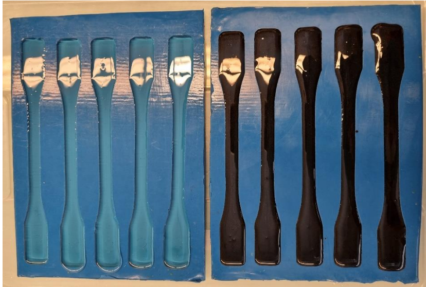
Figura 28 - Provetes tração resina epóxi e compósitos resina epóxi e MWCNT
