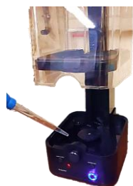
Figura 19 – Introdução da solução alcoólica na máquina de polimento químico.
