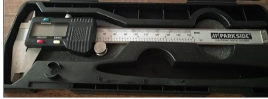
Figura 28 - Paquímetro digital da marca PARKSIDE , utilizado na avaliação dimensional dos provetes de polysmooth .
