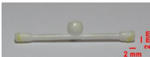
Figura 39 - Molde, em polysmooth , do núcleo perdido, após tratamento químico superficial.
