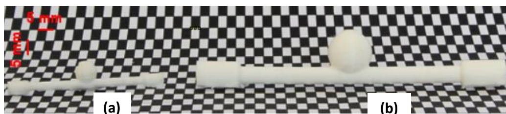
Figura 11 - Biomodelo obtido por impressão 3D, para o material polysmooth , nas duas escalas consideradas: (a) escala reduzida de 50% e (b) escala original.
