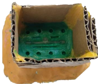
Figura 29 - Estrutura em plasticina que serviu de base à obtenção da primeira parte do molde em silicone.
