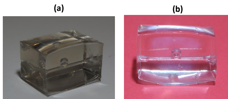
Figura 42 - Alterações sofridas pelo biomodelo, no caso em que foi utilizado um agitador magnético no auxílio à remoção do núcleo perdido de polysmooth .
