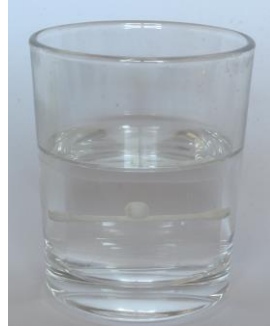
Figura 41 - Biomodelo, com núcleo perdido em polysmooth , imerso em álcool isopropílico.
