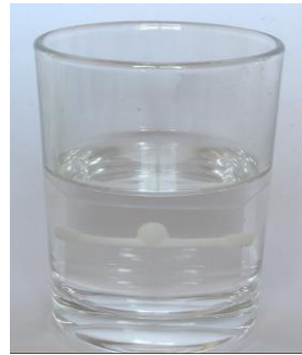
Figura 34 - Biomodelo, com núcleo perdido em sabão à base de glicerina, imerso em álcool isopropílico.
