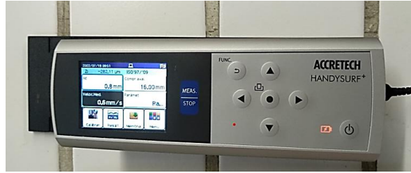
Figura 23 - Rugosímetro da marca ACCRETECH, modelo HANDYSURF, utilizado para efetuar as medições de rugosidade.
