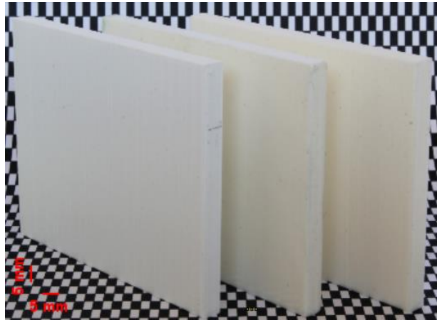
Figura 24 - Provets de PLA e polysmooth utilizados no ensaio de tribologia, com dimensões de 75 mm x 55 mm e com 5 mm de espessura.
