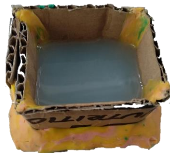
Figura 30 - Silicone vertido, por gravidade, para obtenção da primeira parte do molde bipartido, em silicone.
