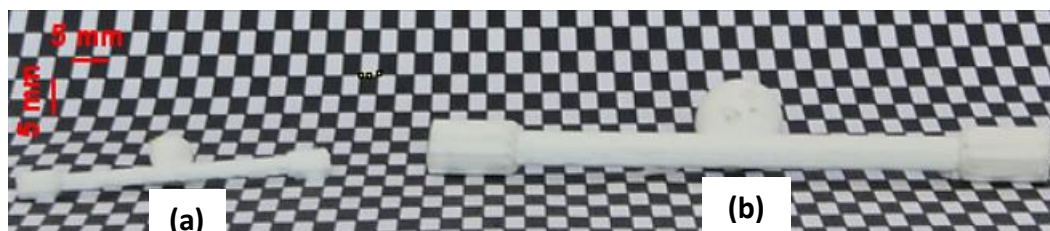
Figura 12 - Biomodelo obtido por impressão 3D, para o material PLA, nas duas escalas consideradas: (a) escala reduzida de 50% e (b) escala original.
