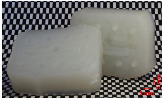
Figura 31 - Molde de silicone bipartido utilizado para a obtenção do núcleo perdido em sabão à base de glicerina.
