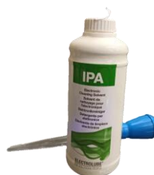
Figura 18 - Solução alcoólica e pipeta utilizadas para a preparação da máquina de polimento químico.
