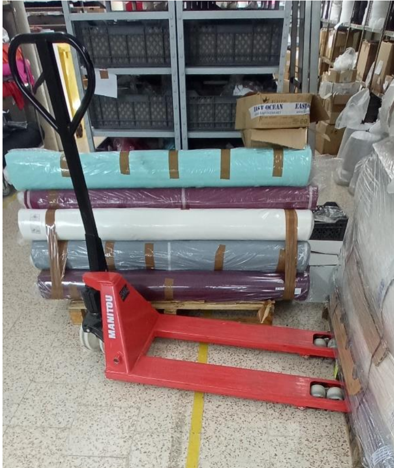
Figura 16- Linhas de segurança não são respeitadas
