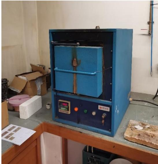
Figura 13: Forno de mufla - Lab. Metalurgia
