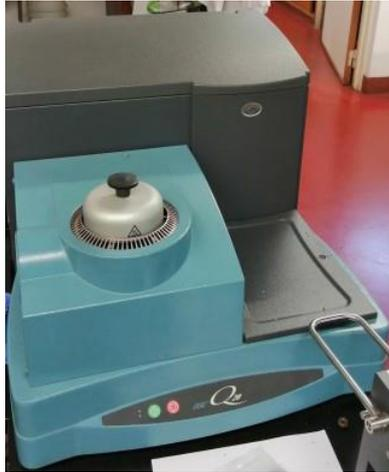
Figura 19 - Equipamento 'DSC Q20'
