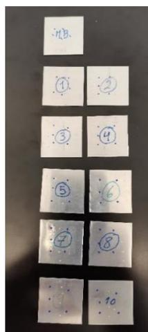
Figura 22 - Ensaio de dureza-Liga de alumínio AW5754-H111
