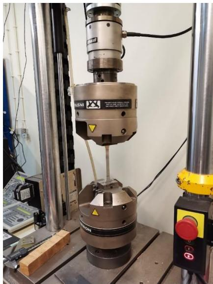
Figura 26 - Máquina universal de ensaios tração/ compressão 'Instron'
