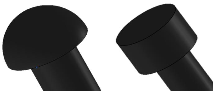
Figura A.0.1 - Representação das possíveis superfícies de contacto do pé com o sensor.
