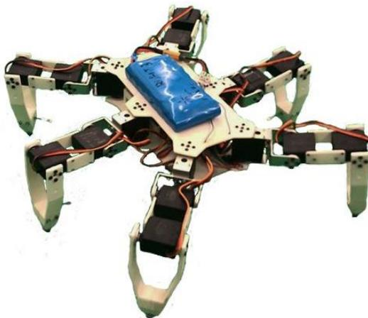
Figura 3.31 - Modelo final do robô hexápode desenvolvido.
