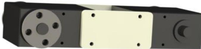
Figura 3.23 - Fémur do hexápode, desenvolvido com recurso ao *software SolidWorks*.
