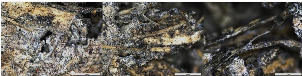
**Figura 7-Mistura CBCA CIBCACAL P1, onde as fibras ficam cobertas com a mistura de cal e cinzas de bagaço de cana-de-açúcar**
