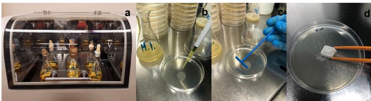
Figura 29- a. Câmara incubadora com agitação orbital de balões de Erlenmeyer com bactérias e nutrientes. b/c. Preparação de placas de agar com bactérias. d. Início do ensaio com as amostras sobre o meio inócuo.
