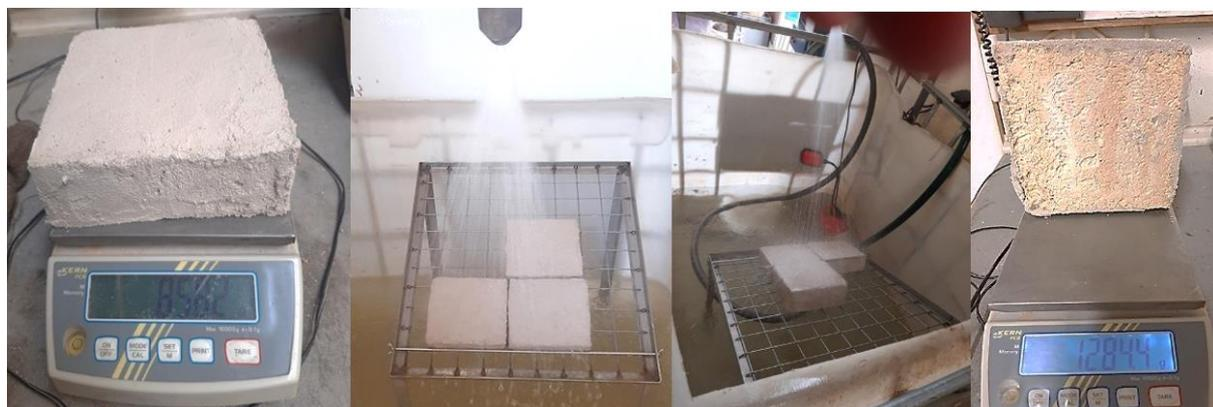
Figura 23- Processo de ensaio de degradação por simulação de chuva
