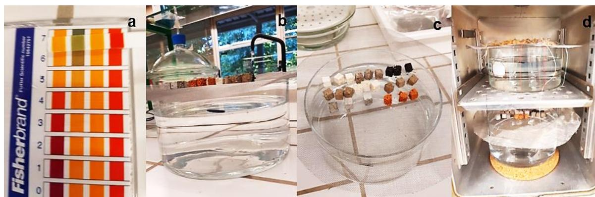
Figura 28- Fisherbrand medição do pH; b. avaliação do nível de água; c/d. misturas sobre a tina com água e amostras na câmara Heraeus a 25°C
