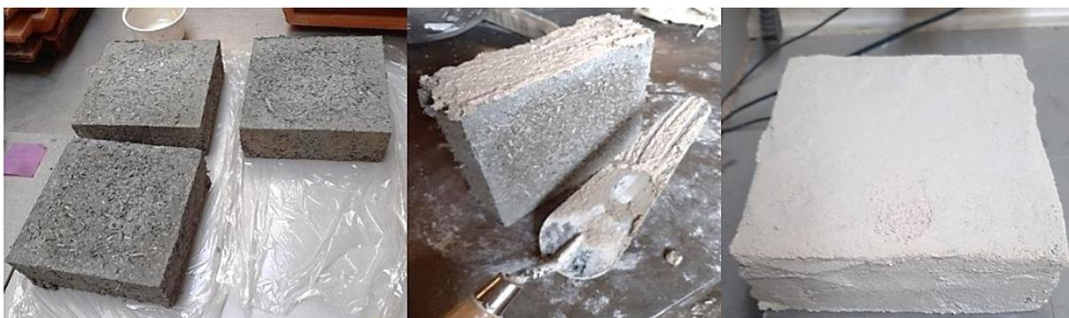
Figura 22- Aplicação de acabamento nas amostras para ensaio de degradação por simulação de chuva
