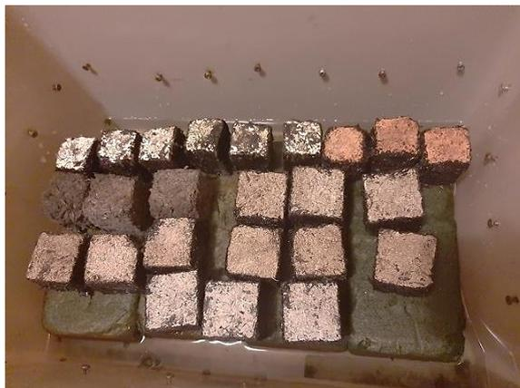
Figura 15 Vista do ensaio de absorção por capilaridade - amostras sobre oásis
