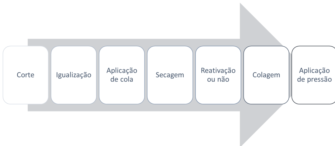
Figura 19. Esquema representativo do processo de produção das amostras.
