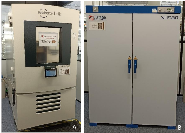
Figura 26. Equipamentos laboratoriais utilizados. A-Câmara climática; B-Estufa.
