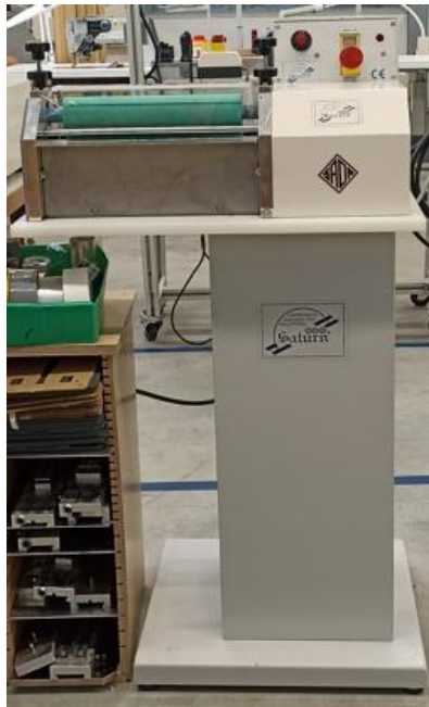
Figura 17. Calandra utilizada no processo de colagem das amostras.
