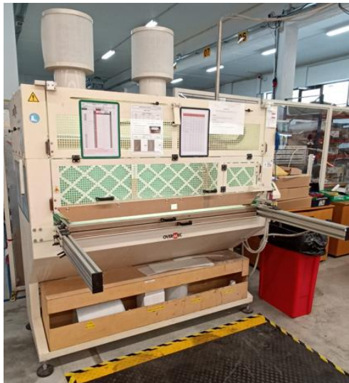
Figura 14. Robot de aplicação cola utilizado no processo de colagem das amostras.
