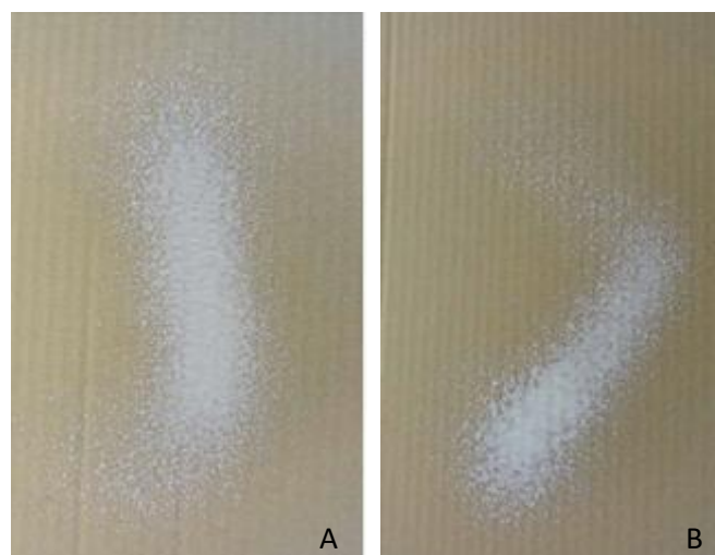
Figura 15. Teste realizado para avaliar a qualidade da dispersão de cola. A-dispersão conforme; B-dispersão não conforme.
