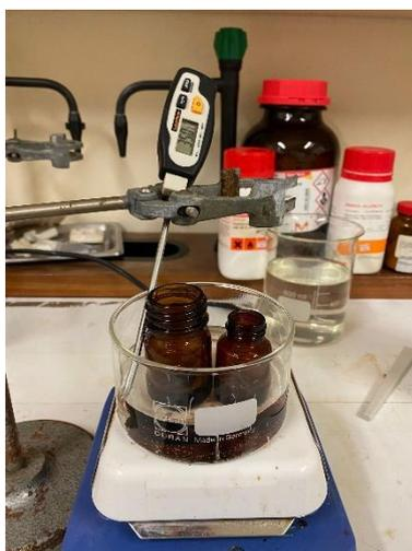
**Figura 21:** Imagem do esquema de montagem utilizado para a síntese de nanovaras de ouro.
