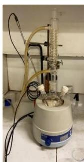
**Figura 19:** Imagem do *setup* experimental utilizado na síntese de nanopartículas magnéticas.
