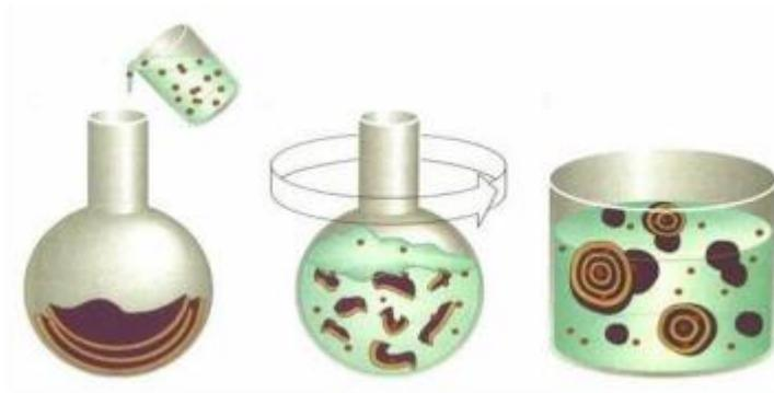
**Figura 16:** Representação esquemática do método de hidratação do filme lipídico. Retirado de (Ferreira, 2006).
