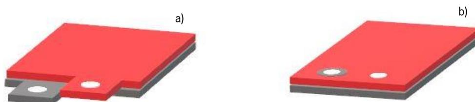
Figura 35 – Conjunto de terminais, sem sobreposição (a), com sobreposição (b).
