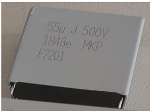
Figura 11 – Exemplo de Condensador de filme MKP 1848 Vishay.
