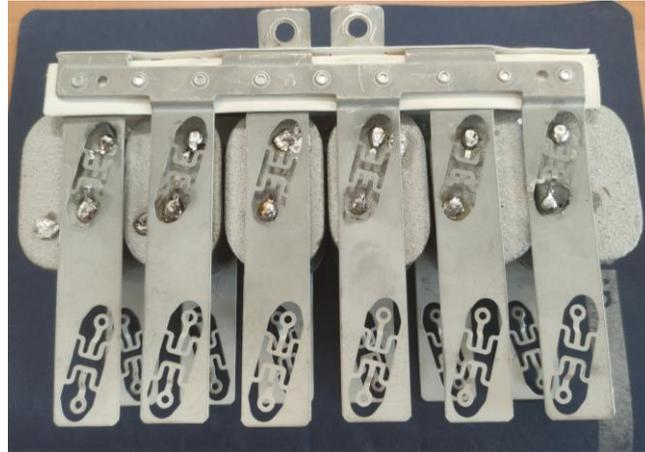
Figura 49 – Barramento com seis condensadores com oposição de polaridades.
