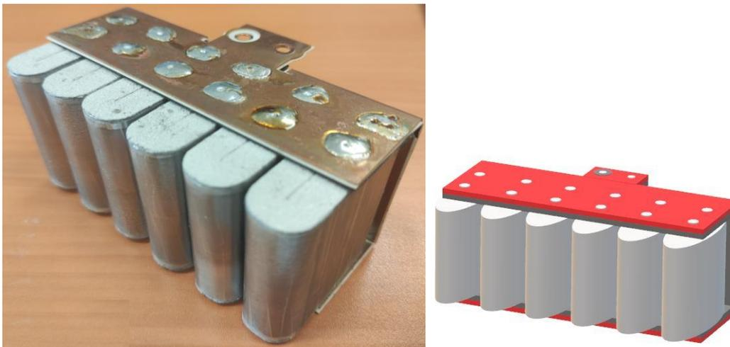
*Figura 60 – Sam-6C - Barramento sobreposto com seis condensadores sem alternância de polaridades.*
