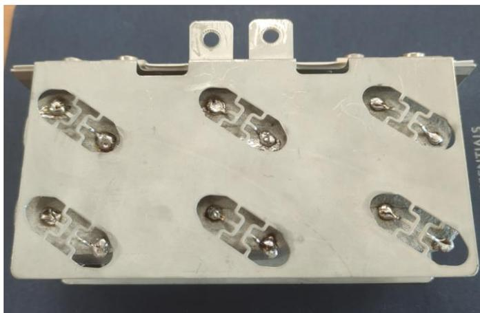
Figura 48 – Barramento com seis condensadores sem oposição de polaridades.
