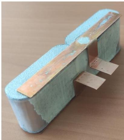
*Figura 55 – Conjunto de dois condensadores de 12,5  $\mu F$  e 27 mm de comprimento.*
