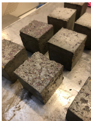
Figura 34 – Provetes após os 56 ciclos do ensaio face ao gelo degelo.
