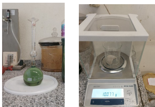
Figura 18 - Procedimentos para obtenção de massa volúmica segundo a NP 954 [55].
