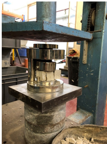
Figura 24- Máquina de compressão ELE após rotura do provete.
