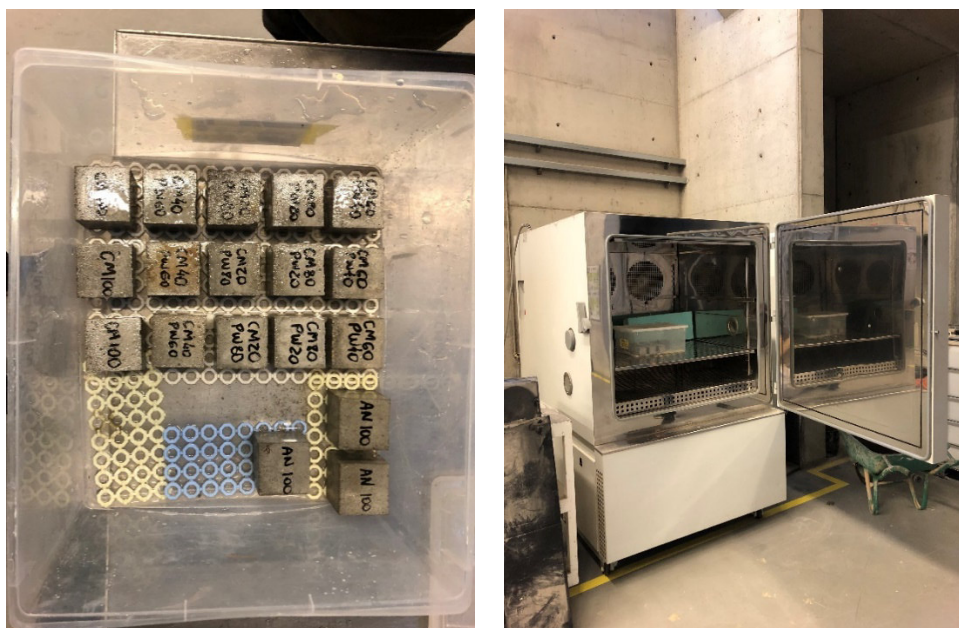
Figura 26 - Colocação dos provetes no equipamento de ensaio.
