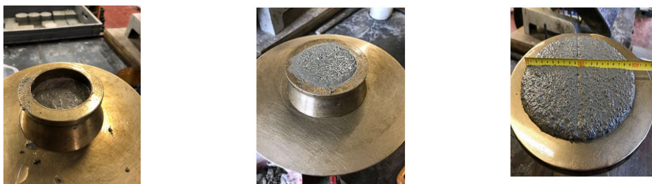
Figura 19 – Ensaio de trabalhabilidade por etapas.
