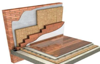
**Figura 40: Isolamento térmico aplicado pelo interior do apartamento**
