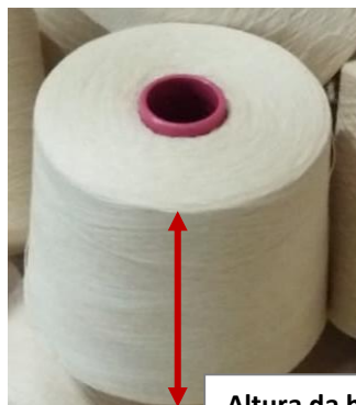
Altura da bobina a medir
