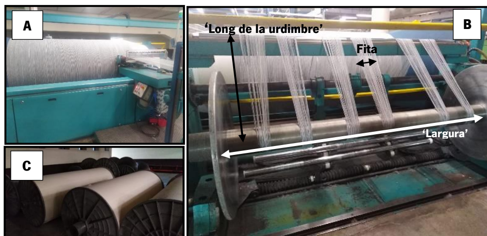
Figura 29 - A: Fio urdido no tambor; B: Repassagem do fio; C: Órgãos
