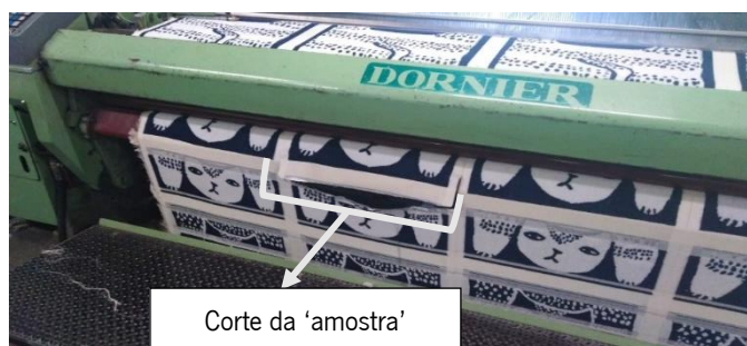
Figura 34 - Corte da 'amostra' de uma produção iniciada
