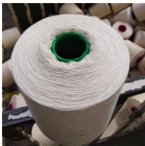
Figura 49 - Bobina com dureza a menos
