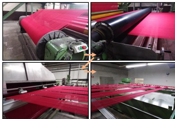
Figura 15 - Representação visual do processo de Encolagem da teia
