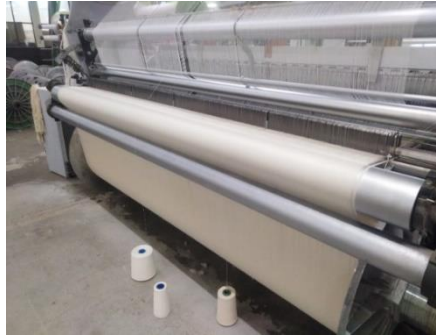
Figura 56 - Teia com fios em falta
