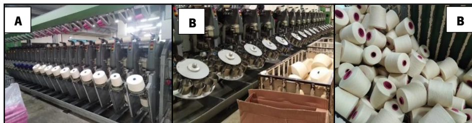
Figura 13 – A: Furos da bobinadeira; B: Bobinas de fio em cones de plástico
