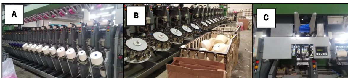
Figura 23 – A: Furos a cola; B: Furos a nó; C: Robô da bobinadeira
