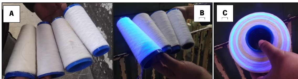
Figura 25 - A: Bobinas de fio com diferentes tonalidades; B e C: Visualização das diferentes tonalidades à luz de forma individual e agrupada em bobina, respetivamente
