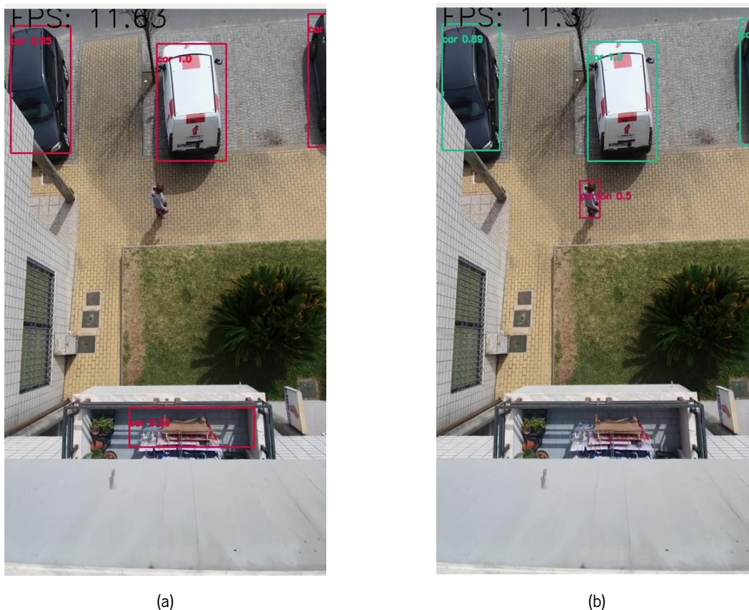
Figura 6.8 -Resultados obtidos do teste com um frame do vídeo às redes com o segundo (a) e terceiro (b) datasets .
