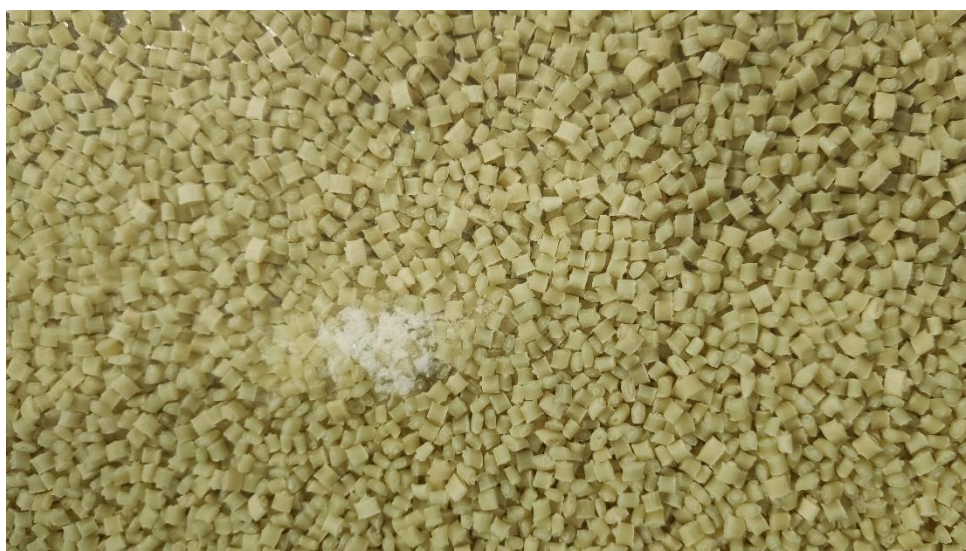
Anexo 10: fibras de vidro acumuladas entre o material
