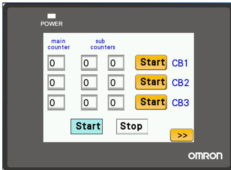
Figura 84 - Visualização e controlo das sequências dos exercícios de reabilitação através do HMI com o modelo omron NB5Q-TW00B (adaptado de [38]).
