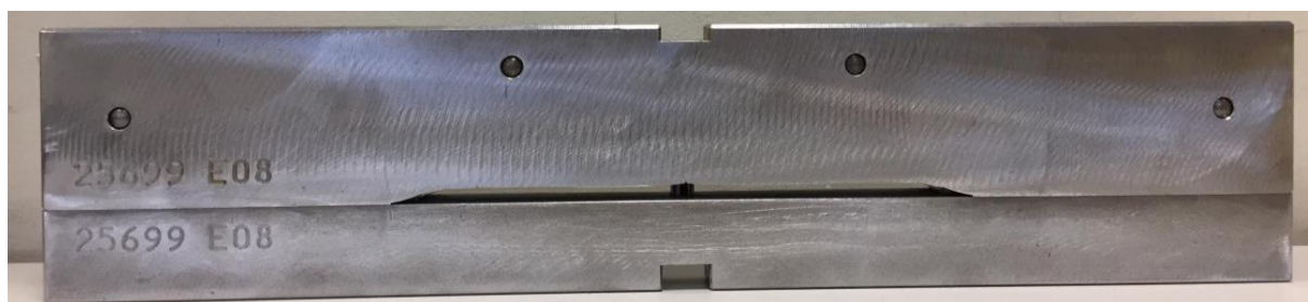
Figura 20 - Feira utilizada para a produção de perfis de pisos. Retirado de: (Costa, 2022)
