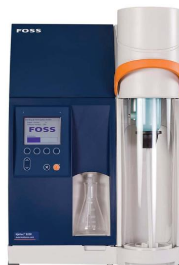
Figura 7. Equipamento Foss Kjeltec 8200 auto distillation. Retirado de Fisher Scientific
